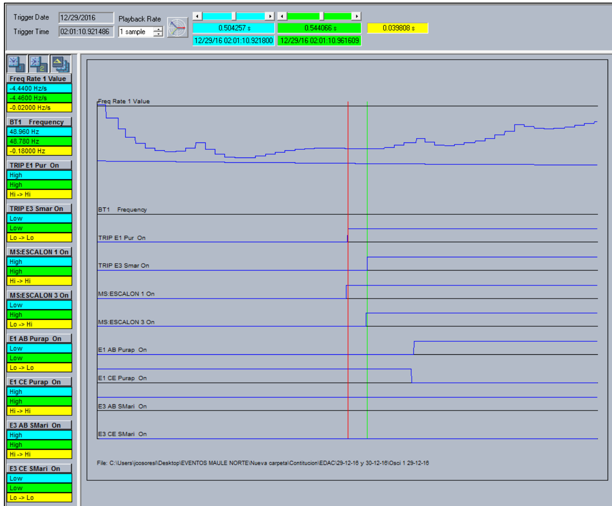
Figura 1. Oscilografía y variables digitales de salida activadas del relé.
