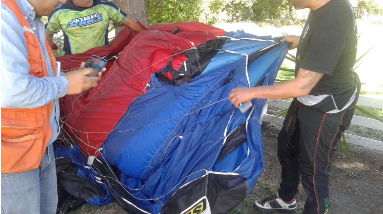
Fotografía N° 7: Muestra de paracaídas dañados con descargas eléctricas.
