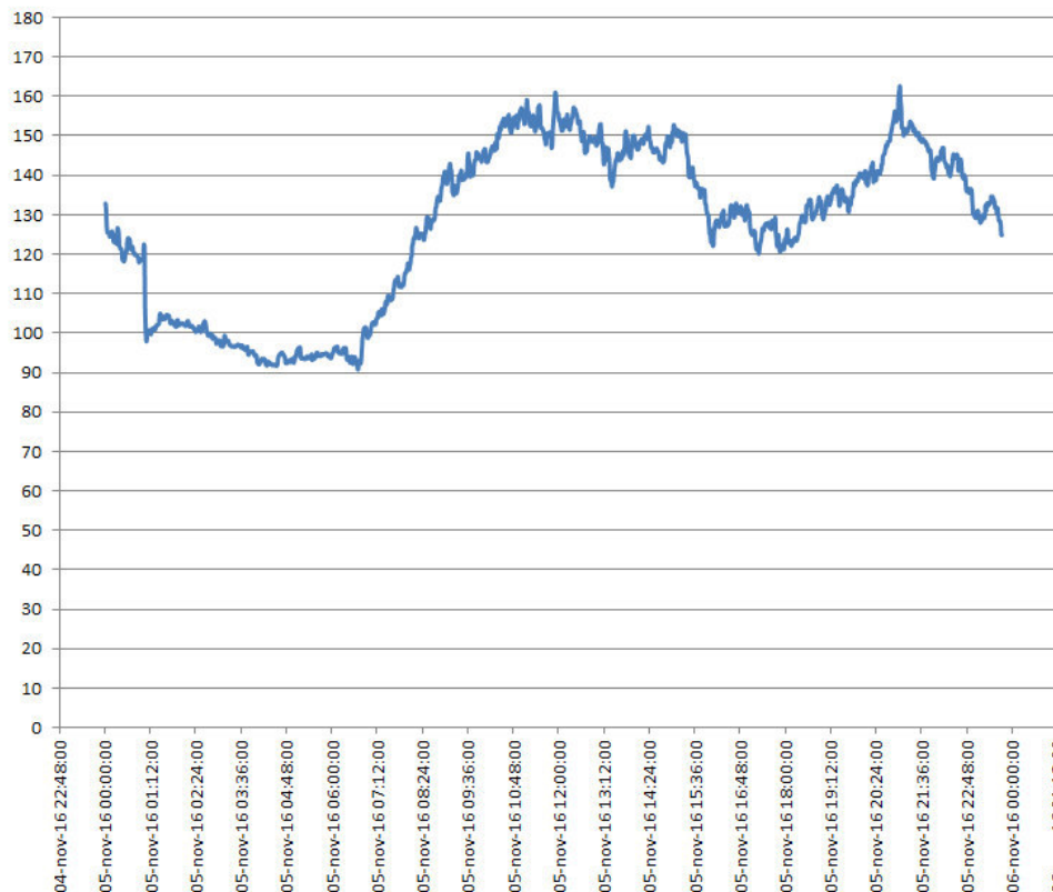
Figura N°3. Diagrama de Tendencia del 05-11-2016 Alimentador 52C4 SE Cauquenes (Incluye barra 23KV SE La Vega)
