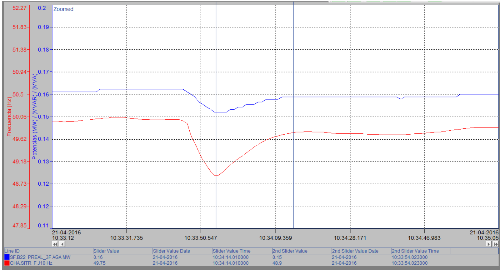
Figura N°4: Tendencia de potencia/frecuencia planta AGA.
