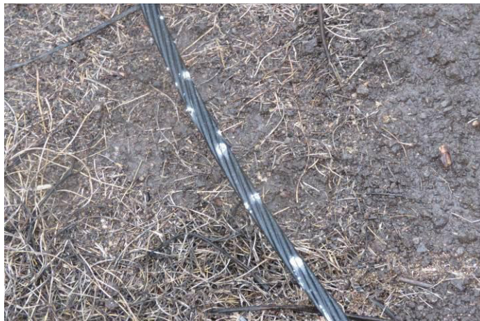
Foto: Muestras de descargas sobre el conductor Foto: Aislador descargado y reventado
