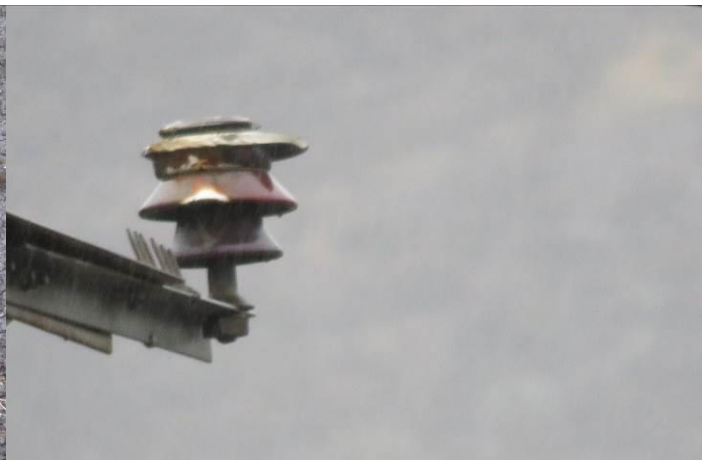
Foto: Muestras de descargas sobre el conductor Foto: Aislador descargado y reventado
