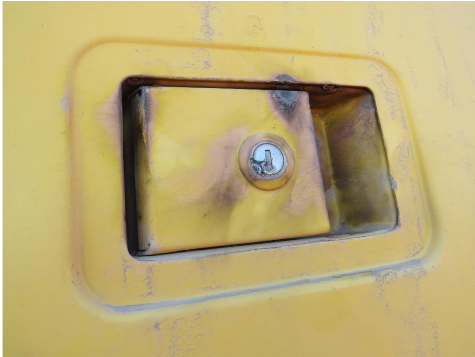
Fotografía N° 11. Evidencia de descarga en máquina retroexcavadora causante de los daños a la línea
