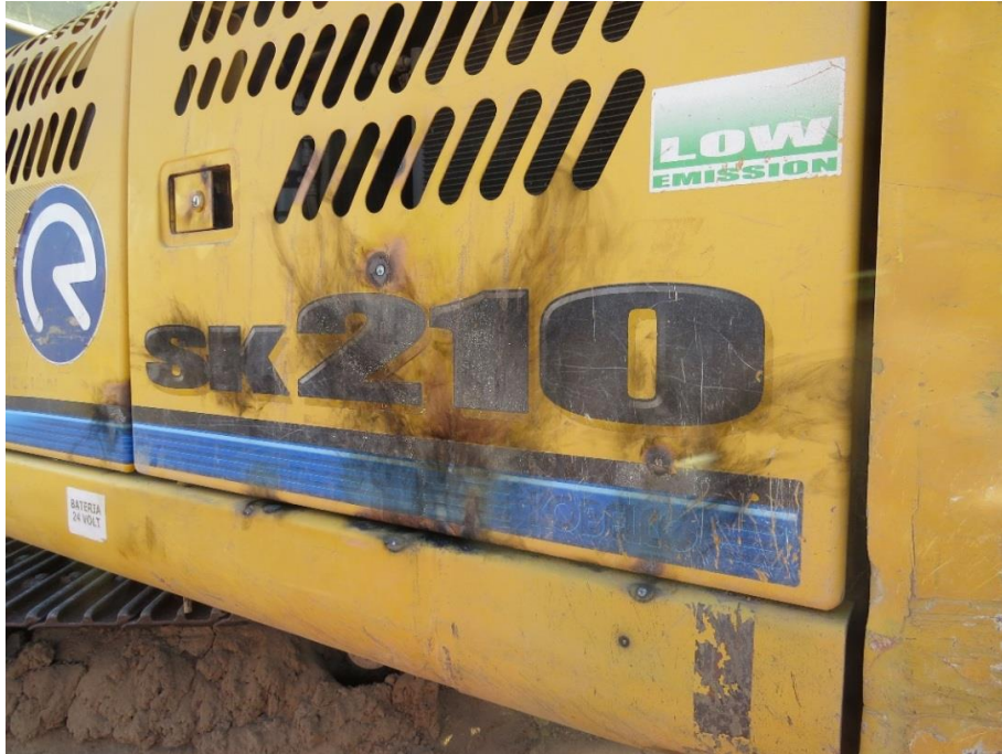
Fotografía N° 10. Evidencia de descarga en máquina retroexcavadora causante de los daños a la línea
