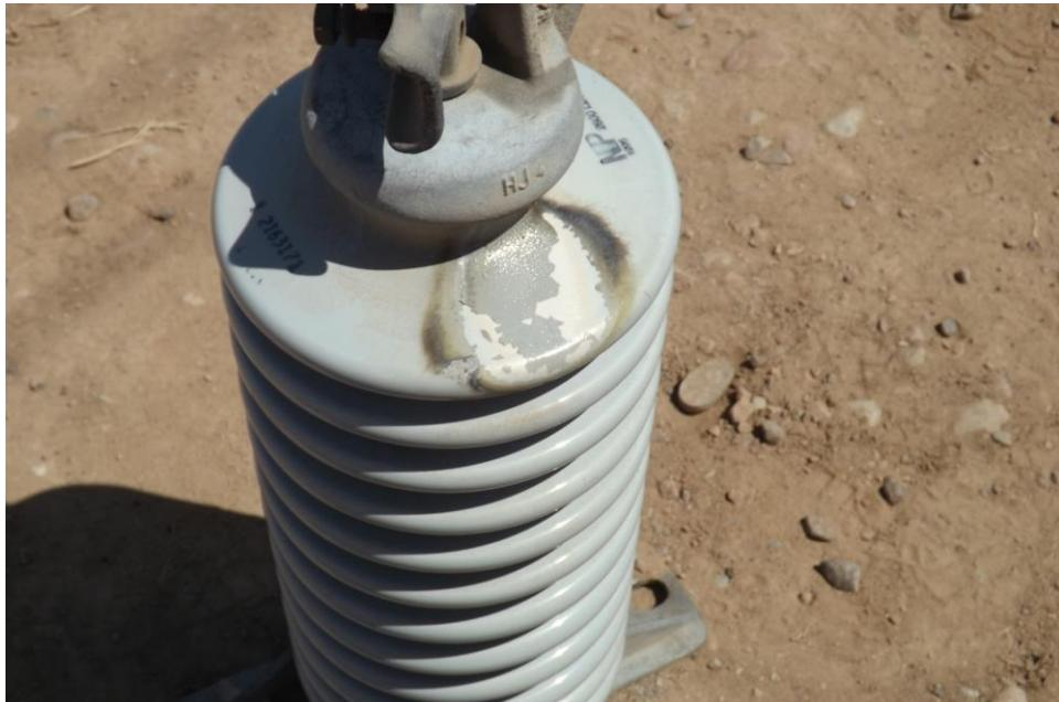
Aislador Linepost con evidente Flashover en estructura N°9A
