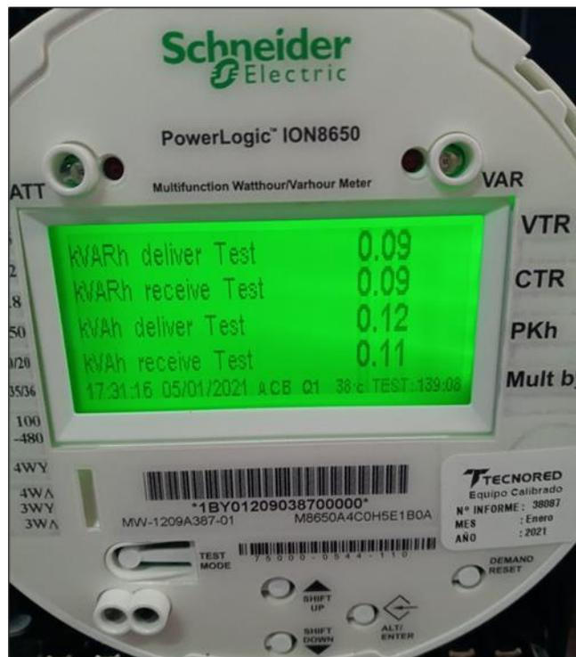
Figura 9-22 – Equipo medidor ION 8650 – Potencia neta U2
