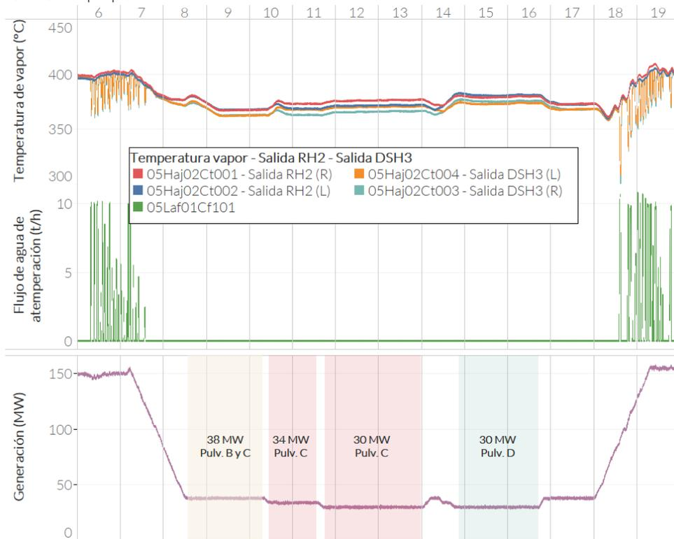
El análisis del efecto de la atemperación ilustrado en la Figura 24, dividido por cada molino en operación, se presenta a continuación:
