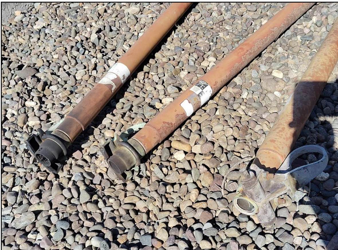
Figura 2: Fusibles con descargas.
