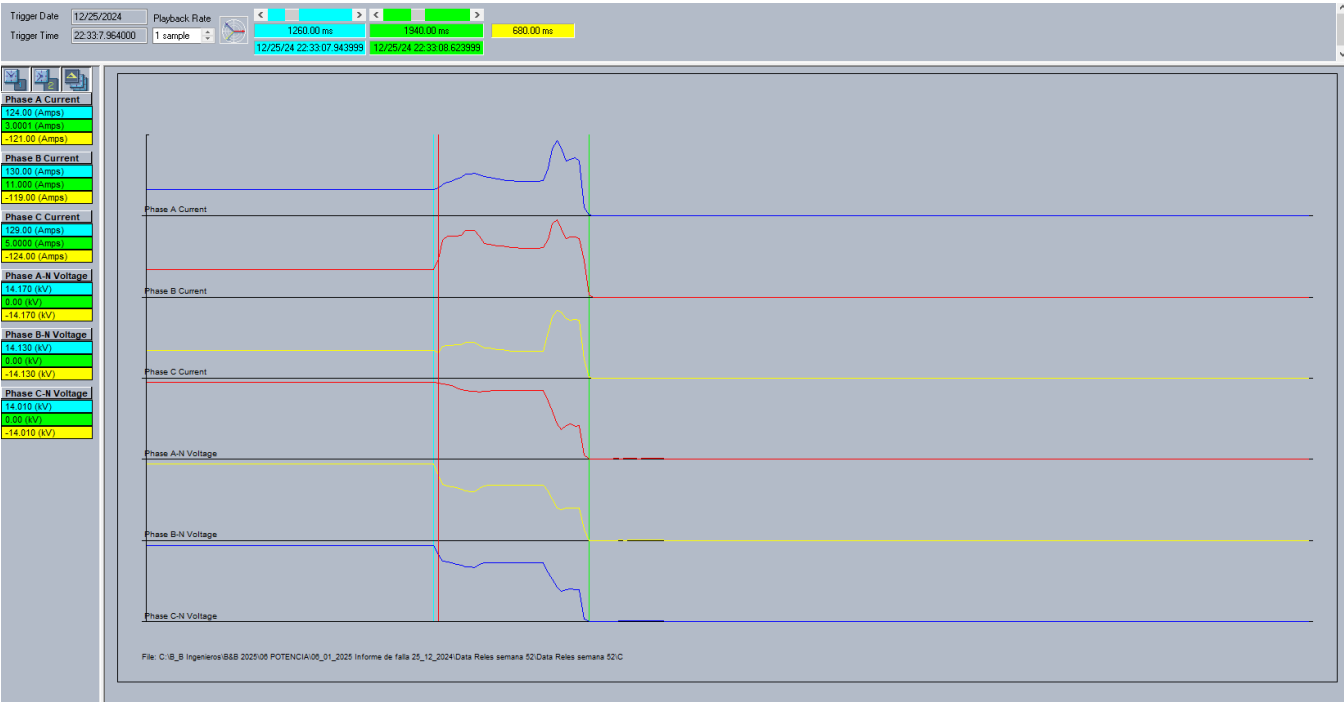
Figura 1: Registro de oscilográfico relé GE 750.
