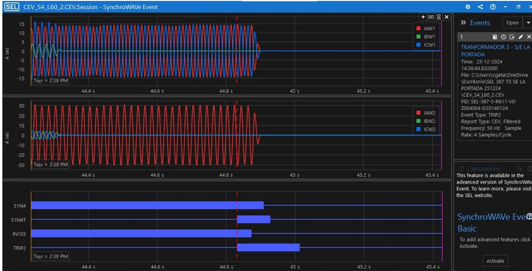
Oscilografía 1 de Relé SEL 387\_87T\_52HT3 Transformador T3 SE La Portada. Finalización falla.
