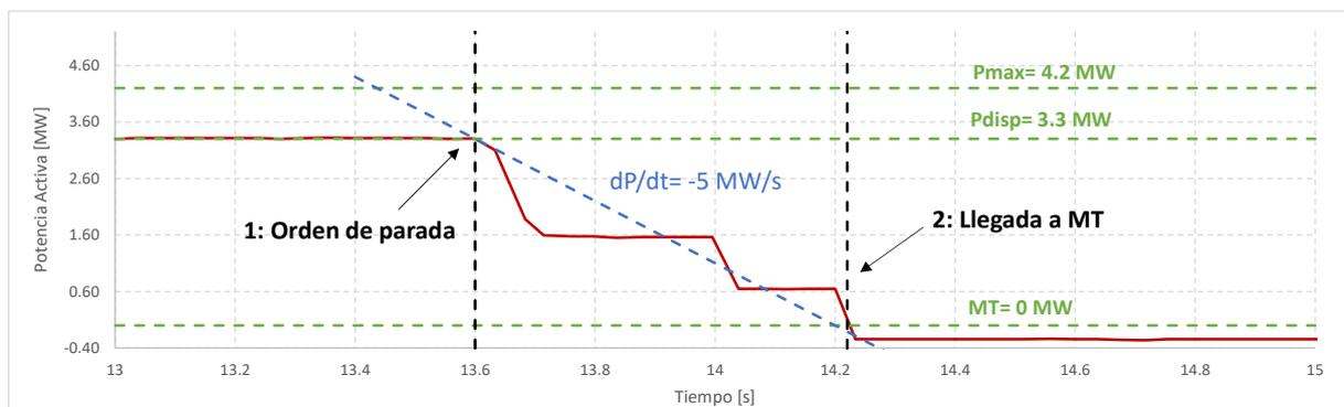
**Gráfico 14. Detalle del proceso de detención a nivel inversor.**
