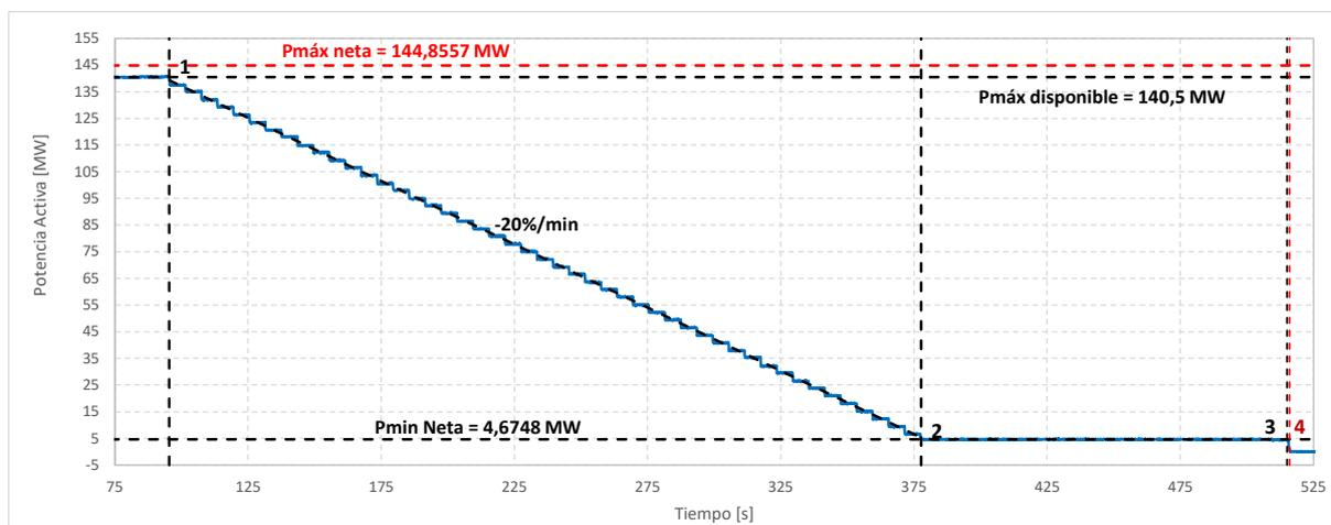
**Gráfico 11. Detalle del proceso de detención para el parque completo.**
