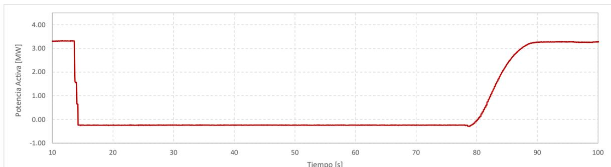
**Gráfico 13. Potencia activa durante el proceso de partida y detención a nivel inversor.**
