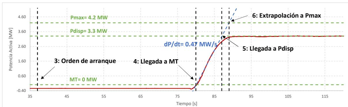
**Gráfico 15. Detalle del proceso de arranque a nivel inversor.**
