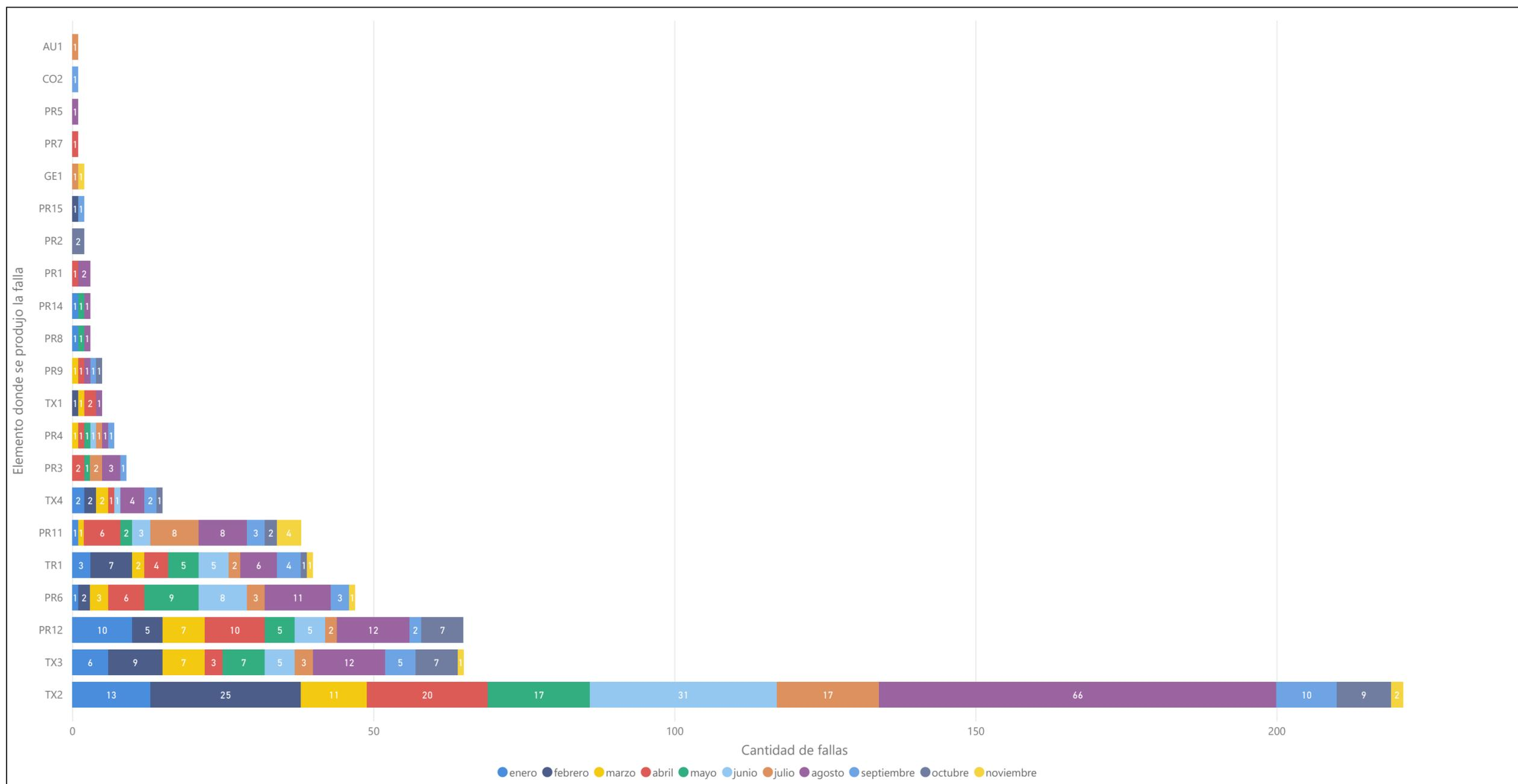
El gráfico de la figura anterior muestra la distribución de la cantidad de fallas en instalaciones del SEN según el "Elemento" del sistema de transmisión donde se originó la falla, hasta el mes de noviembre de 2024.
