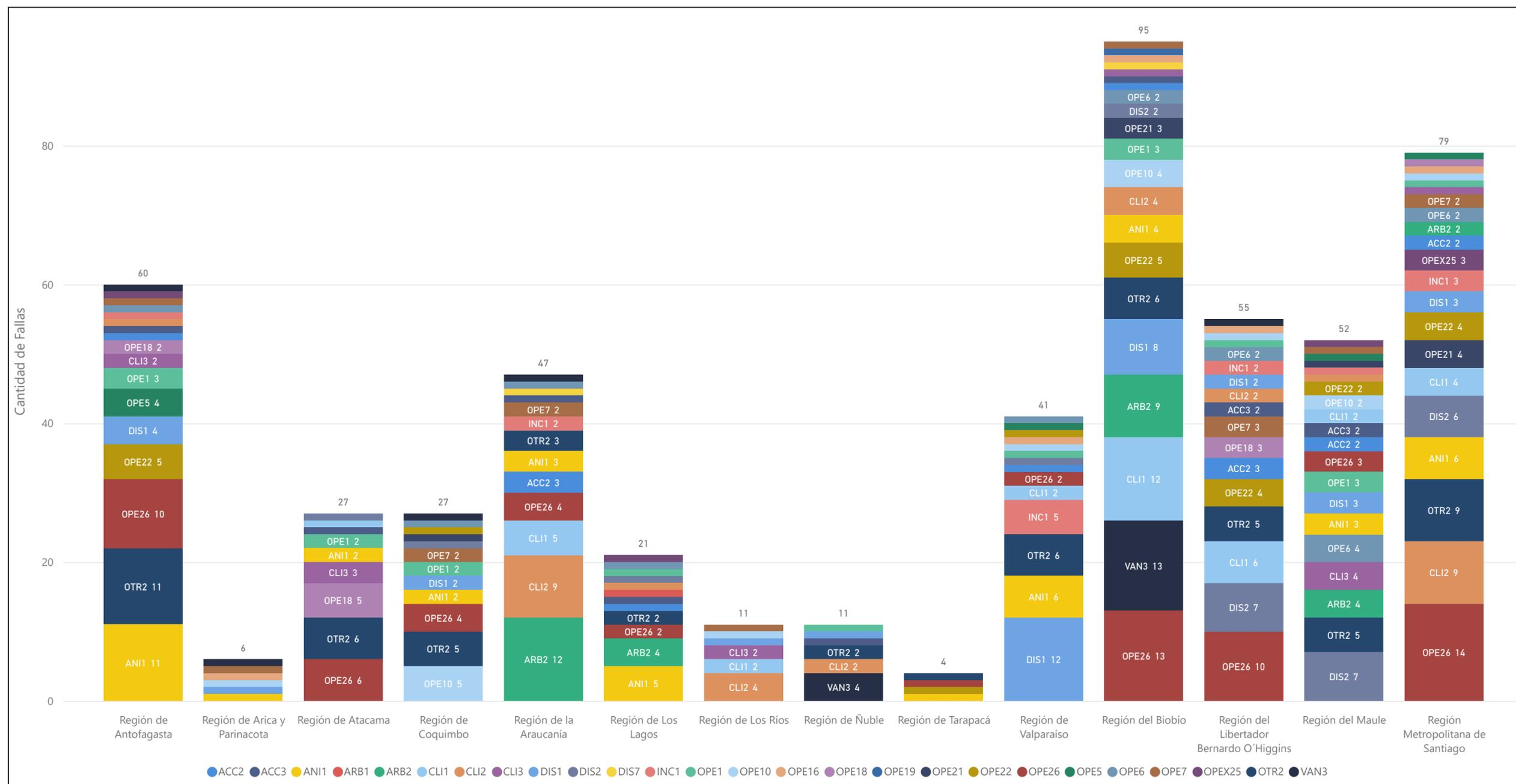
El gráfico de la figura anterior muestra la distribución por región de la cantidad de fallas en instalaciones del SEN que afectaron de manera directa consumos de clientes, hasta el mes de noviembre de 2024, según el "Fenómeno Físico" que originó la falla en el "Elemento" del sistema de transmisión.
