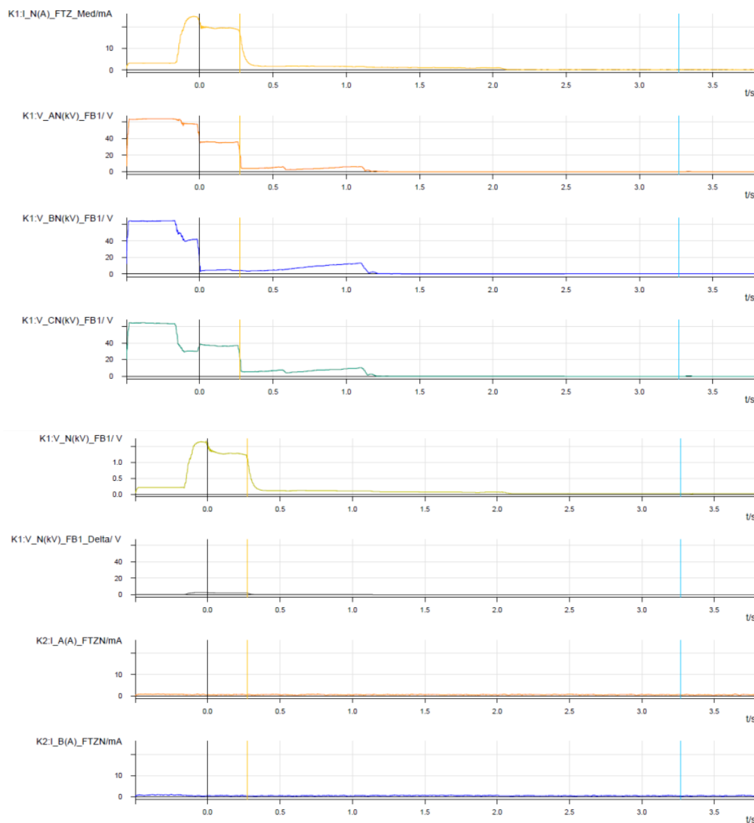
Registros oscilográficos SP1 del paño FTZ de S/E El Manzano
