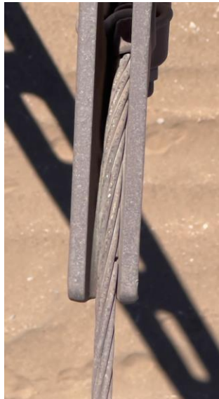
Fotografía 1: Hebra cortada de la fase B de la estructura N°127
