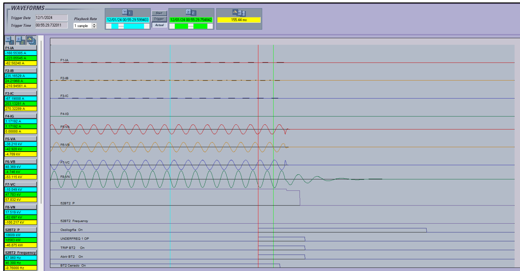
Figura 8.4: Oscilografía de protección L90, paño 52BT2 central autoprodutora Celco.
