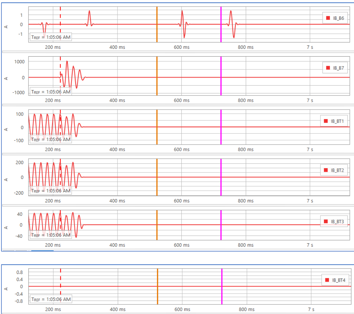
Figura N°7. Oscilografía del segundo evento de Operación del esquema SEL-87B en su función 50BF de la SE Talca, corrientes fase B
