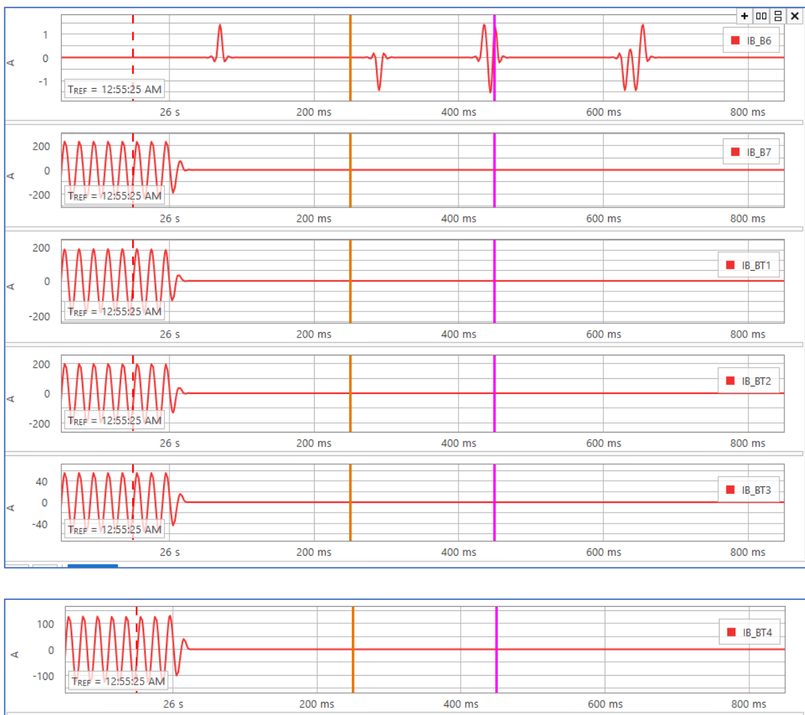
Figura N°3. Oscilografía del evento de Operación del esquema SEL-487B en su función 50BF de la SE Talca, corrientes fase B
