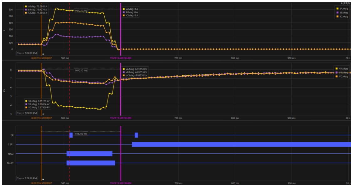
Figura 15 Oscilografía de SEL 300G Unidad 2 Central Laja.
