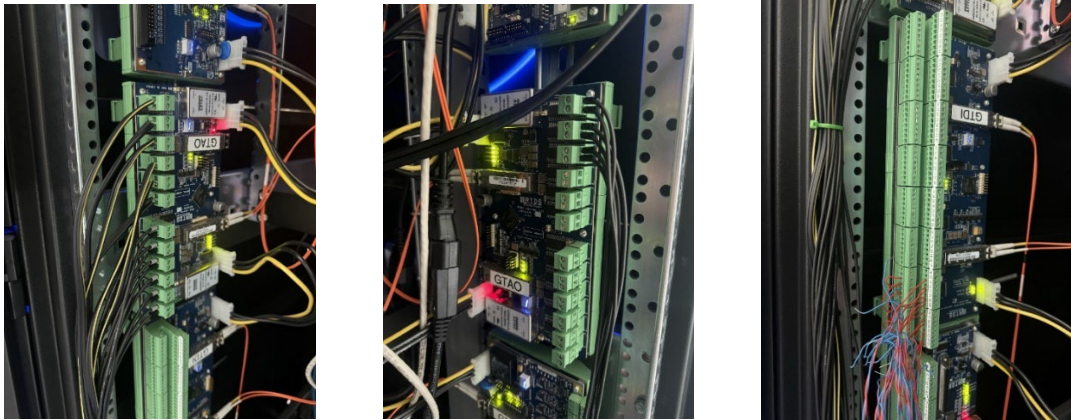
Figura 13: Conexión de señales analógicas y digitales en Simulador Novacor 1.0 (RTDS Technologies).
