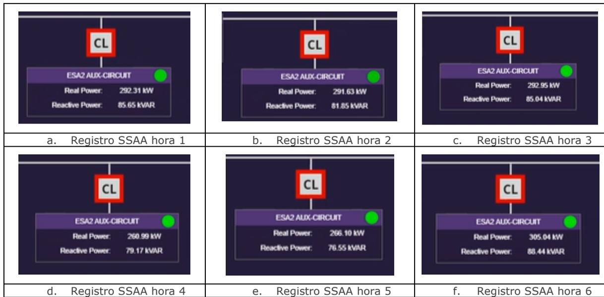
**Gráfico 22. Consumo de servicios auxiliares del sistema BESS en condición de potencia máxima en proceso de descarga.**
