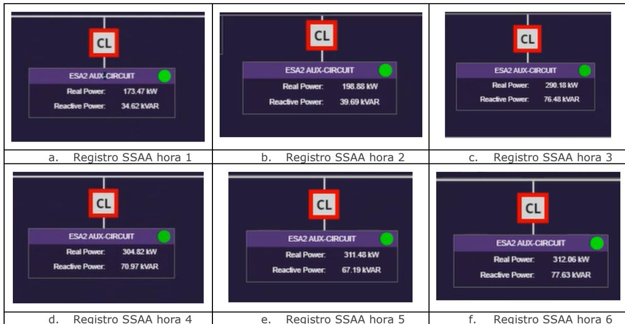
**Gráfico 16. Consumo de servicios auxiliares del sistema BESS en condición de potencia máxima en proceso de carga.**
