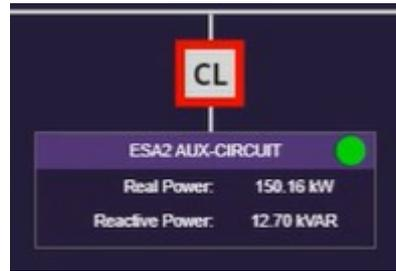
**Gráfico 45. Consumo de servicios auxiliares del sistema BESS en condición de mínimo técnico en modo descarga.**
