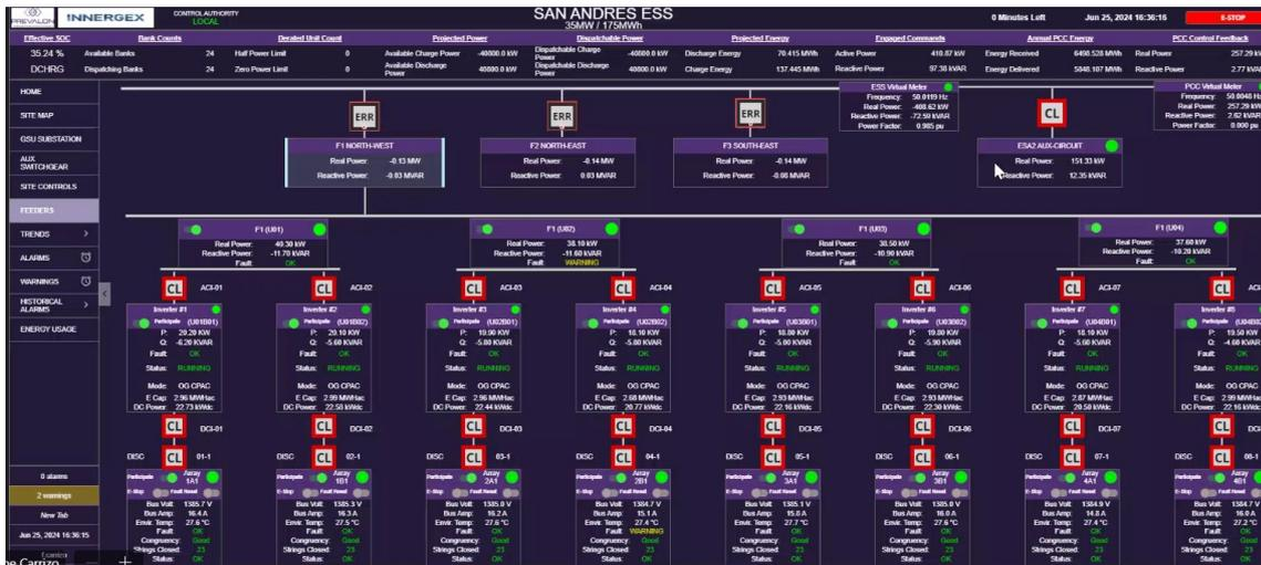
Gráfico 40. Estado de inyección de inversores durante el ensayo de mínimo técnico conjunto. Colector 1.
