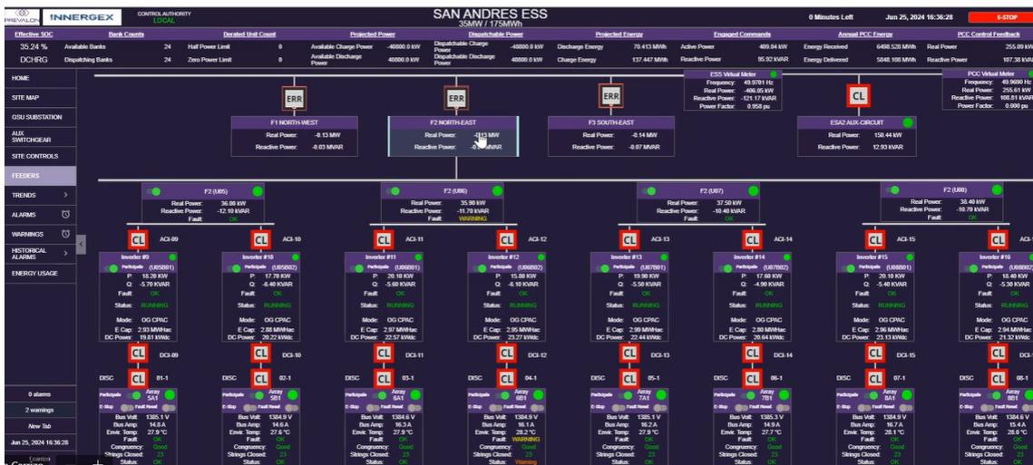
Gráfico 41. Estado de inyección de inversores durante el ensayo de mínimo técnico conjunto. Colector 2.
