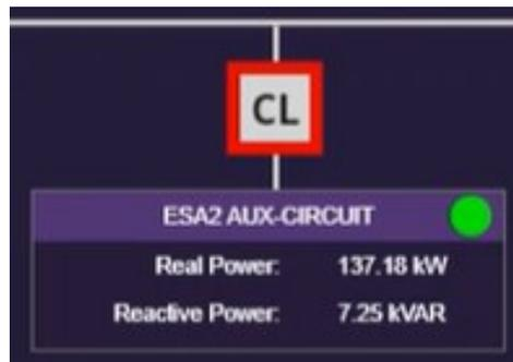
**Gráfico 36. Consumo de servicios auxiliares del sistema BESS en condición de mínimo técnico en modo carga.**
