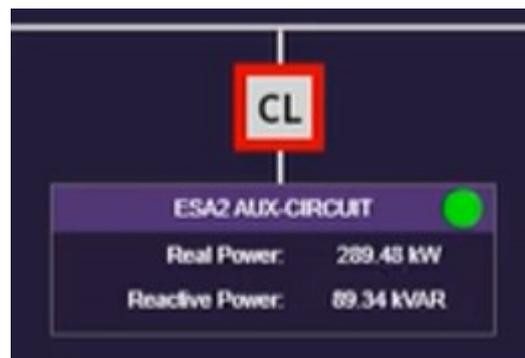
**Gráfico 15. Consumo de servicios auxiliares del sistema BESS en condición de mínimo técnico de planta.**
