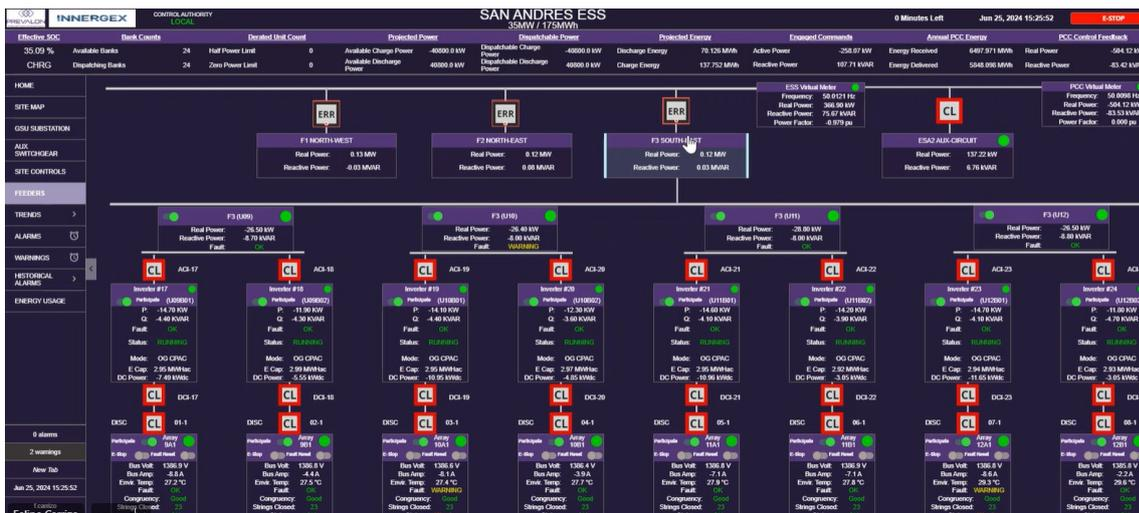
Gráfico 31. Estado de inyección de inversores durante el ensayo de mínimo técnico conjunto. Colector 3.
