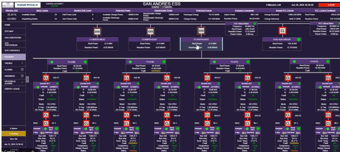
**Gráfico 42. Estado de inyección de inversores durante el ensayo de mínimo técnico conjunto. Colector 3.**
