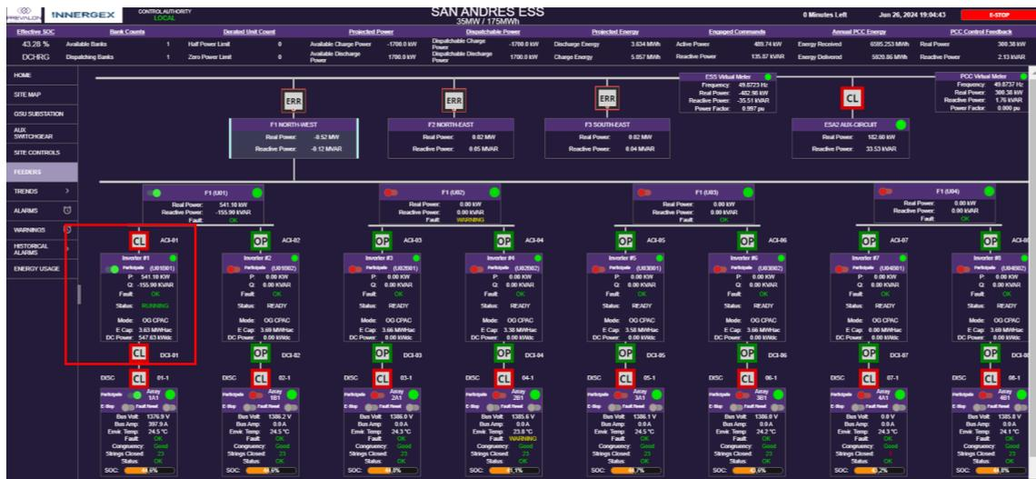
**Gráfico 18. Potencia bruta en el INV #1 para operación a mínimo técnico con un inversor en servicio.**
