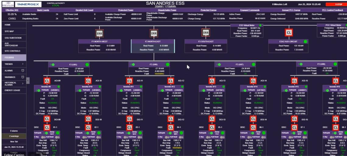
Gráfico 30. Estado de inyección de inversores durante el ensayo de mínimo técnico conjunto. Colector 2.
