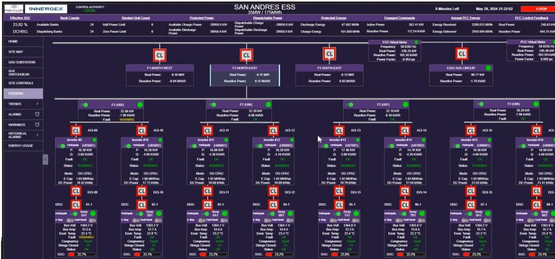
**Gráfico 23. Estado de inyección de inversores durante el ensayo de mínimo técnico. Colector 2**
