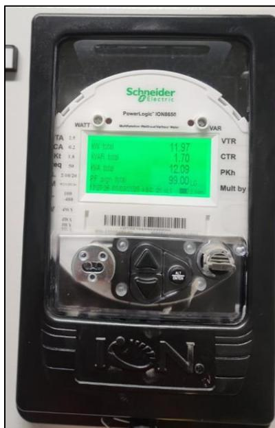
Figura 7-3: Medición de las pérdidas de servicios auxiliares.
