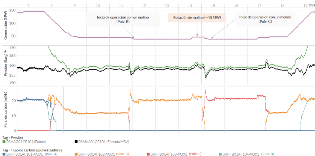
Figura 13 Cronología de 05-03-2024; Generación (imagen superior), presión en el domo y presión de vapor (imagen central), y flujo de carbón a pulverizadores (imagen inferior). Fuente: Elaboración propia.
