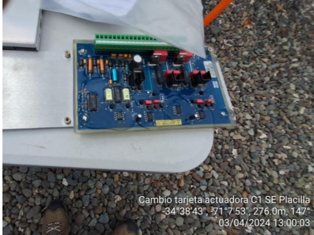
Figura 1.- La fotografía muestra la tarjeta actuadora usada en reemplazo a la tarjeta actuadora que provocaba la desconexión forzada del Cto. Peñuela paño C2 en SE placilla.
