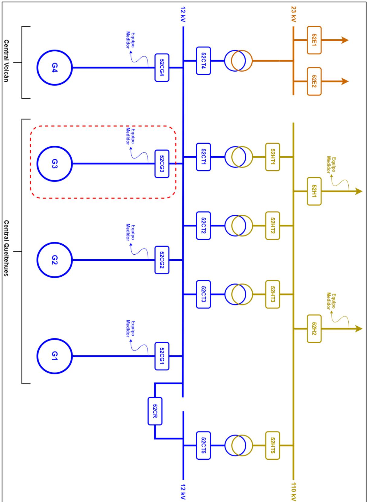
Figura 3.2 – Diagrama unilíneal simplificado
