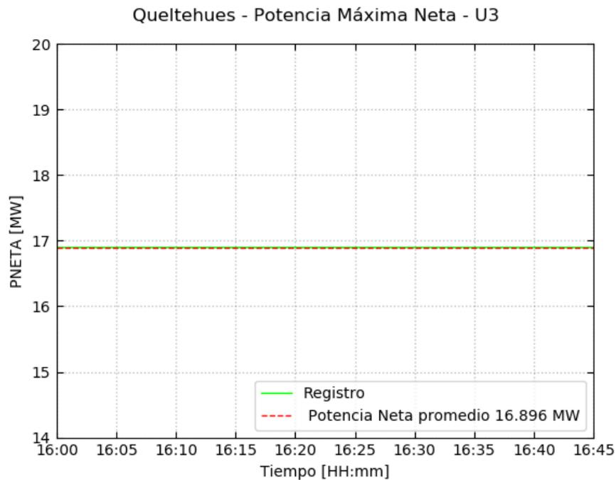
Figura 4.2 – Ensayo de Potencia Máxima - PNETA
