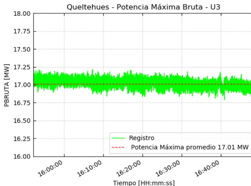
Figura 4.1 – Ensayo de Potencia Máxima – PBRUTA
