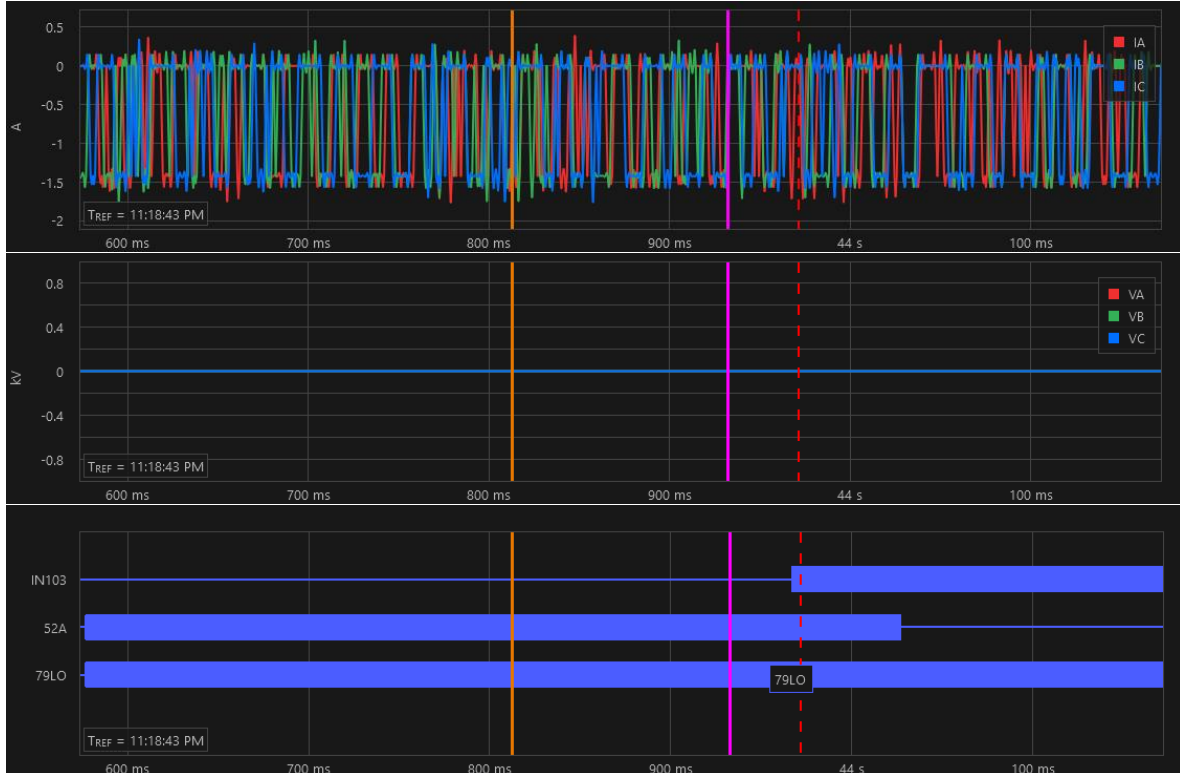
Registro oscilográfico Relé SEL 351R de Paño C4 SE LEBU
