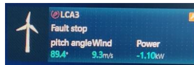
Figura 4-3: Estado del aerogenerador WTG03 durante el ensayo de mínimo técnico
