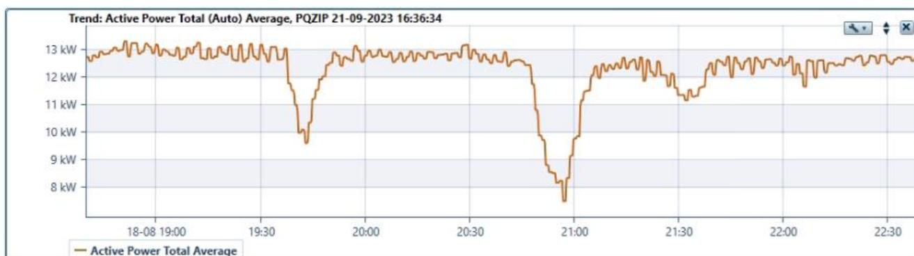
**Figura 5.6: Registros de potencia activa SS.AA. BESS 2. Prueba de potencia máxima (Descarga).**
