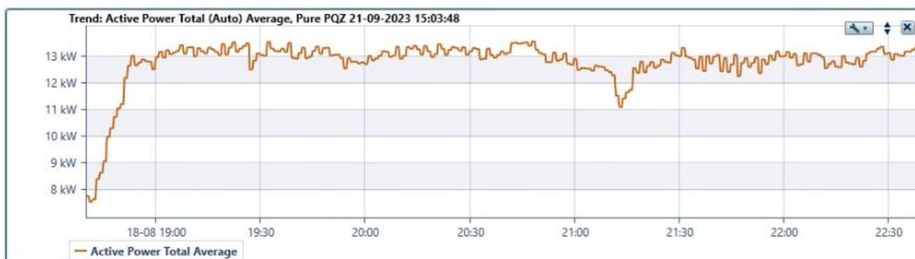
**Figura 5.5: Registros de potencia activa SS.AA. BESS 1. Prueba de potencia máxima (Descarga).**
