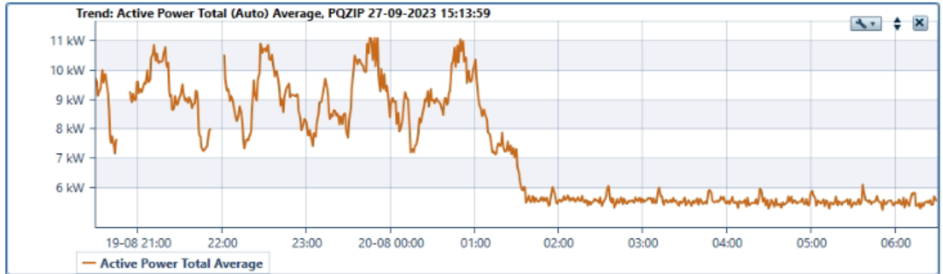
Figura 5.20: Registros de potencia activa SS.AA. BESS 2. Prueba de mínimo técnico (Descarga).
