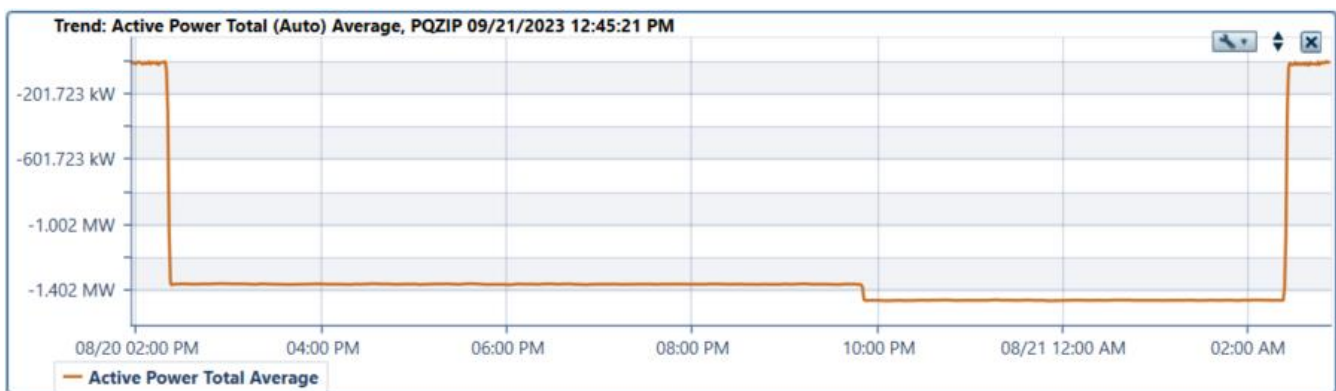
Figura 5.23: Registros de potencia activa en paño F1 SE Inca de Oro. Prueba de mínimo técnico ciclo de trabajo (Carga).
