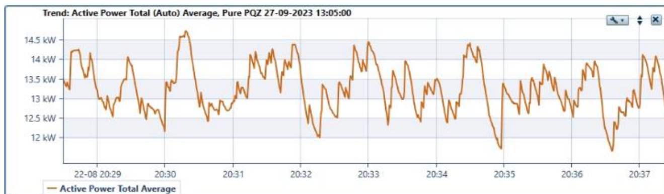
Figura 5.13: Registros de potencia activa SS.AA. BESS 1. Prueba de mínimo técnico (Descarga).
