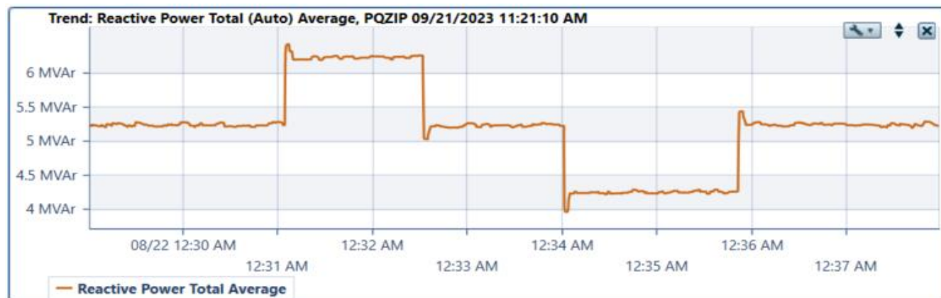
Figura 5.4: Registros de potencia reactiva en paño J1 SE Inca de Oro. Prueba de mínimo técnico (Descarga).
