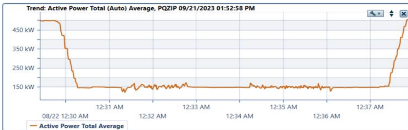
Figura 5.6: Registros de potencia activa en paño F17 SE Inca de Oro. Prueba de mínimo técnico (Descarga).
