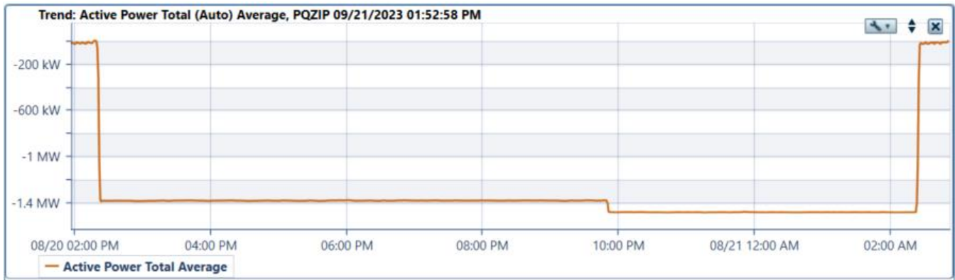
Figura 5.24: Registros de potencia activa en paño F17 SE Inca de Oro. Prueba de mínimo técnico ciclo de trabajo (Carga).
