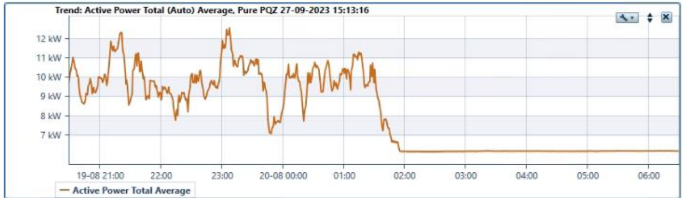
Figura 5.19: Registros de potencia activa SS.AA. BESS 1. Prueba de mínimo técnico (Descarga).
