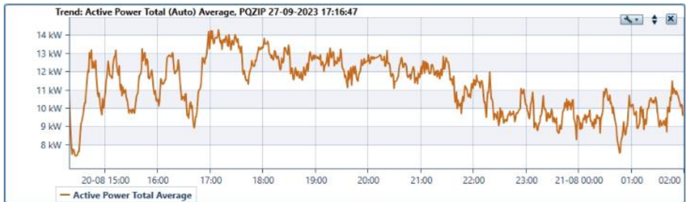
Figura 5.26: Registros de potencia activa SS.AA. BESS 2. Prueba de mínimo técnico ciclo de trabajo (Carga).
