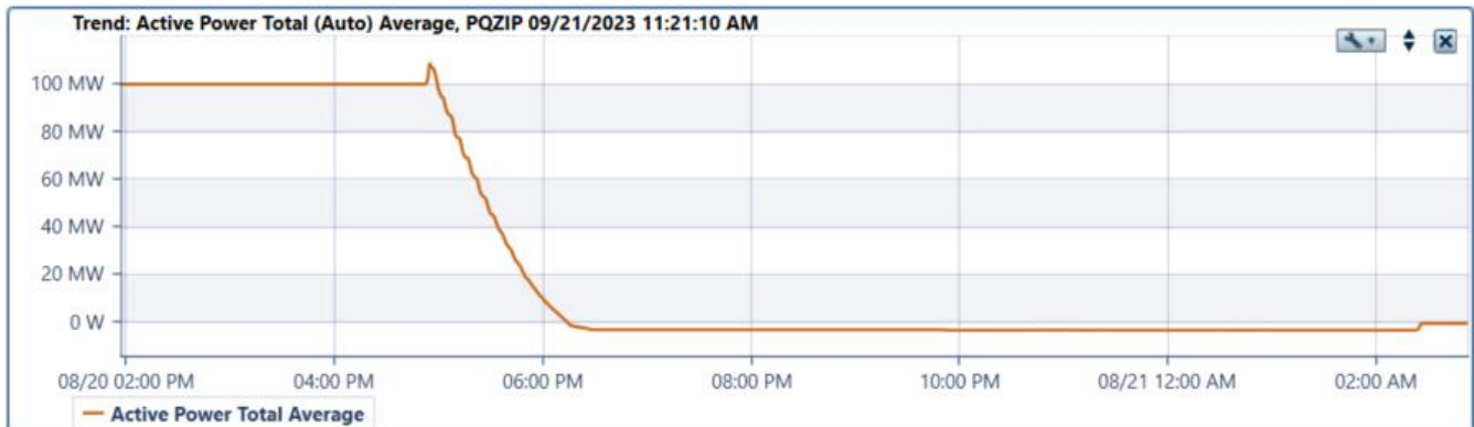
Figura 5.21: Registros de potencia activa en paño J1 SE Inca de Oro. Prueba de mínimo técnico ciclo de trabajo (Carga).
