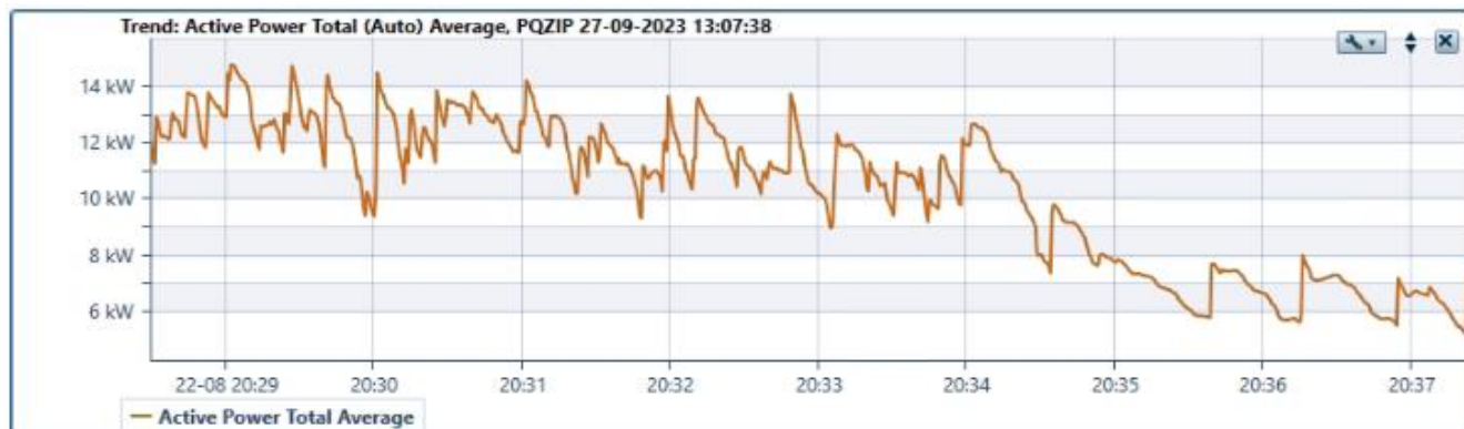
Figura 5.14: Registros de potencia activa SS.AA. BESS 2. Prueba de mínimo técnico (Descarga).
