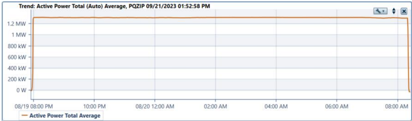
Figura 5.18: Registros de potencia activa en paño F17 SE Inca de Oro. Prueba de mínimo técnico (Descarga).
