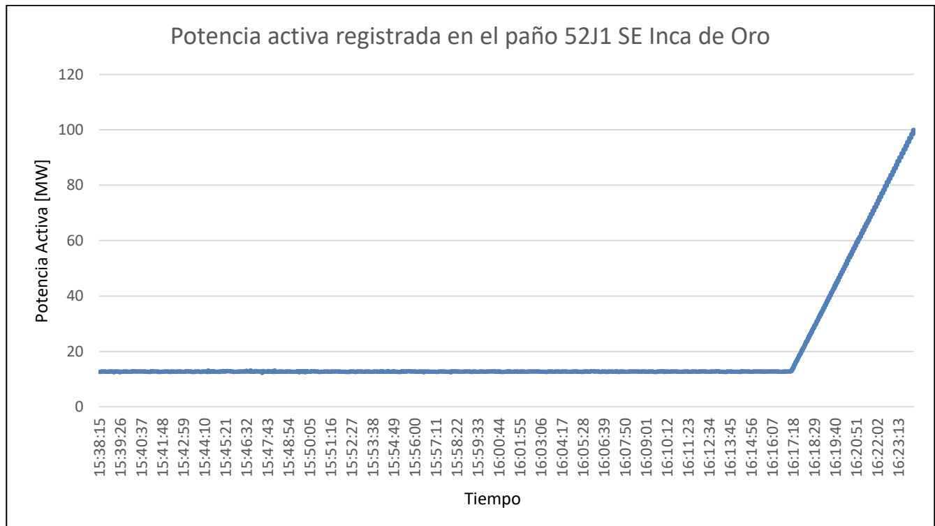
Figura 4.1: Registro de potencia a mínimo técnico [MW] en el paño 52J1 de la SE Inca de Oro, el día 02-06-2022.
