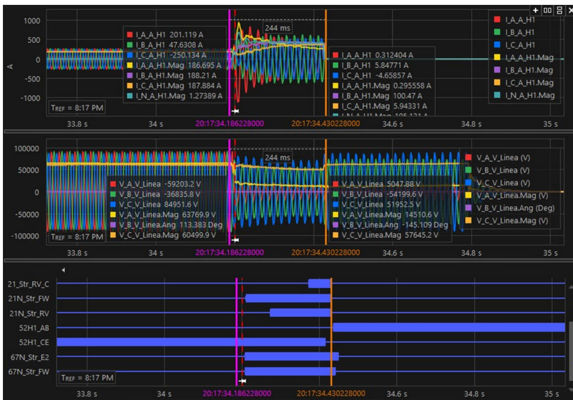
Figura 3.17: Extracto registro oscilográfico protección Sistema 2 REL670
