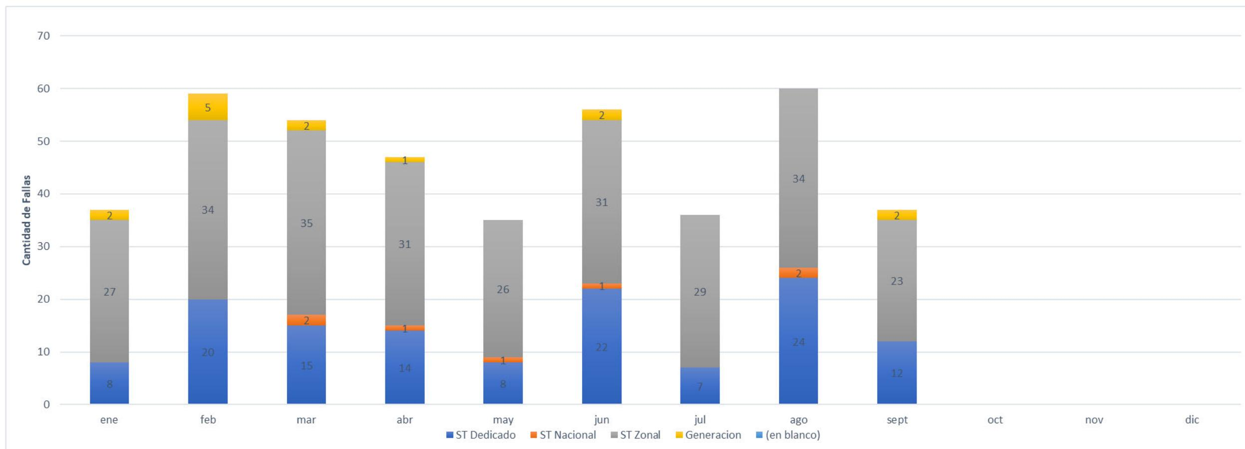
El gráfico de la figura anterior muestra la distribución mensual de la cantidad de fallas en instalaciones del SEN que afectaron de manera directa consumos de clientes, hasta el mes de septiembre de 2023, según el segmento de la instalación del sistema de transmisión donde se originó la falla.
