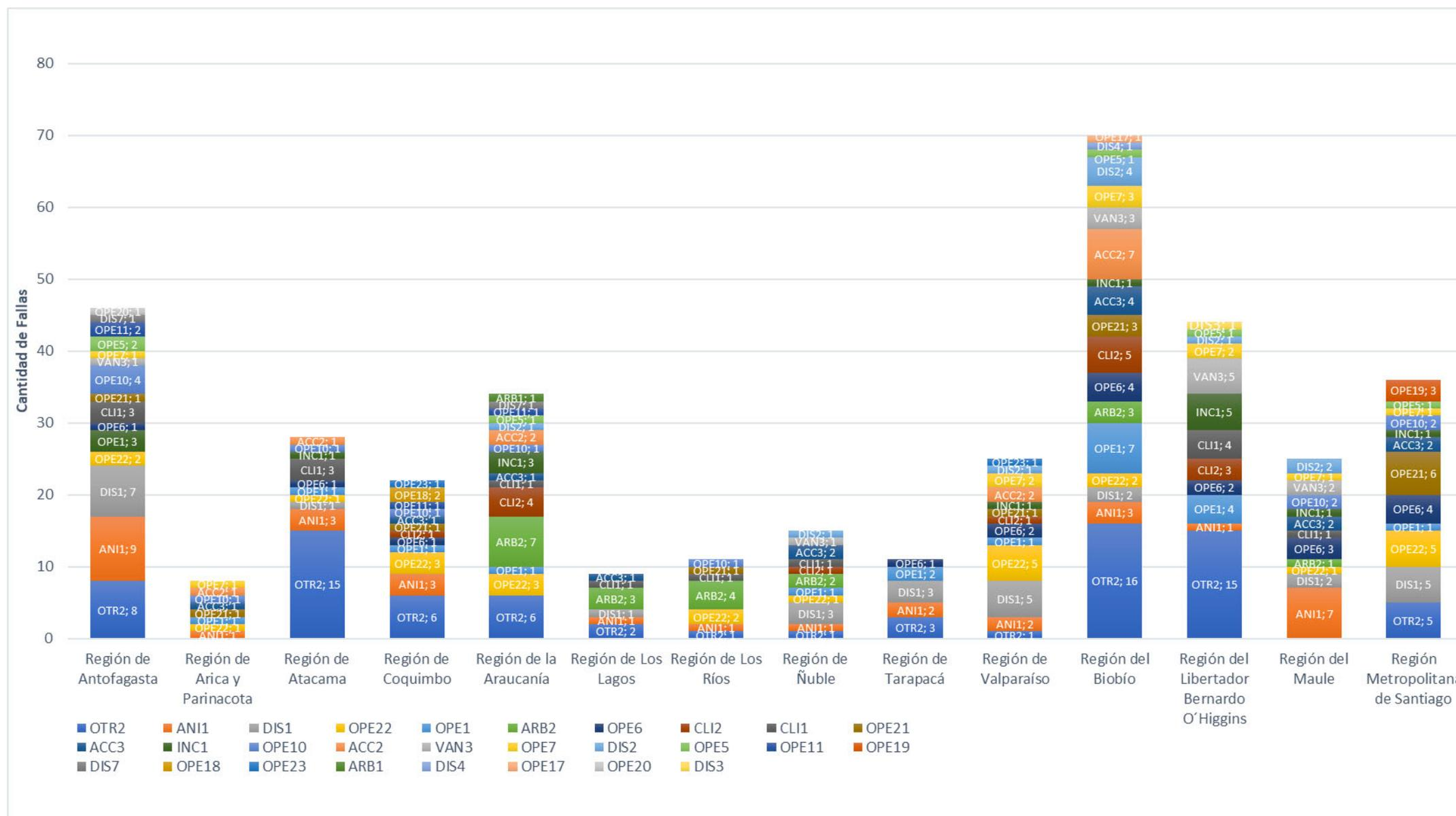
El gráfico de la figura anterior muestra la distribución por región de la cantidad de fallas en instalaciones del SEN que afectaron de manera directa consumos de clientes, hasta el mes de septiembre de 2023, según el “Fenómeno Físico” que originó la falla en el “Elemento” del sistema de transmisión.
