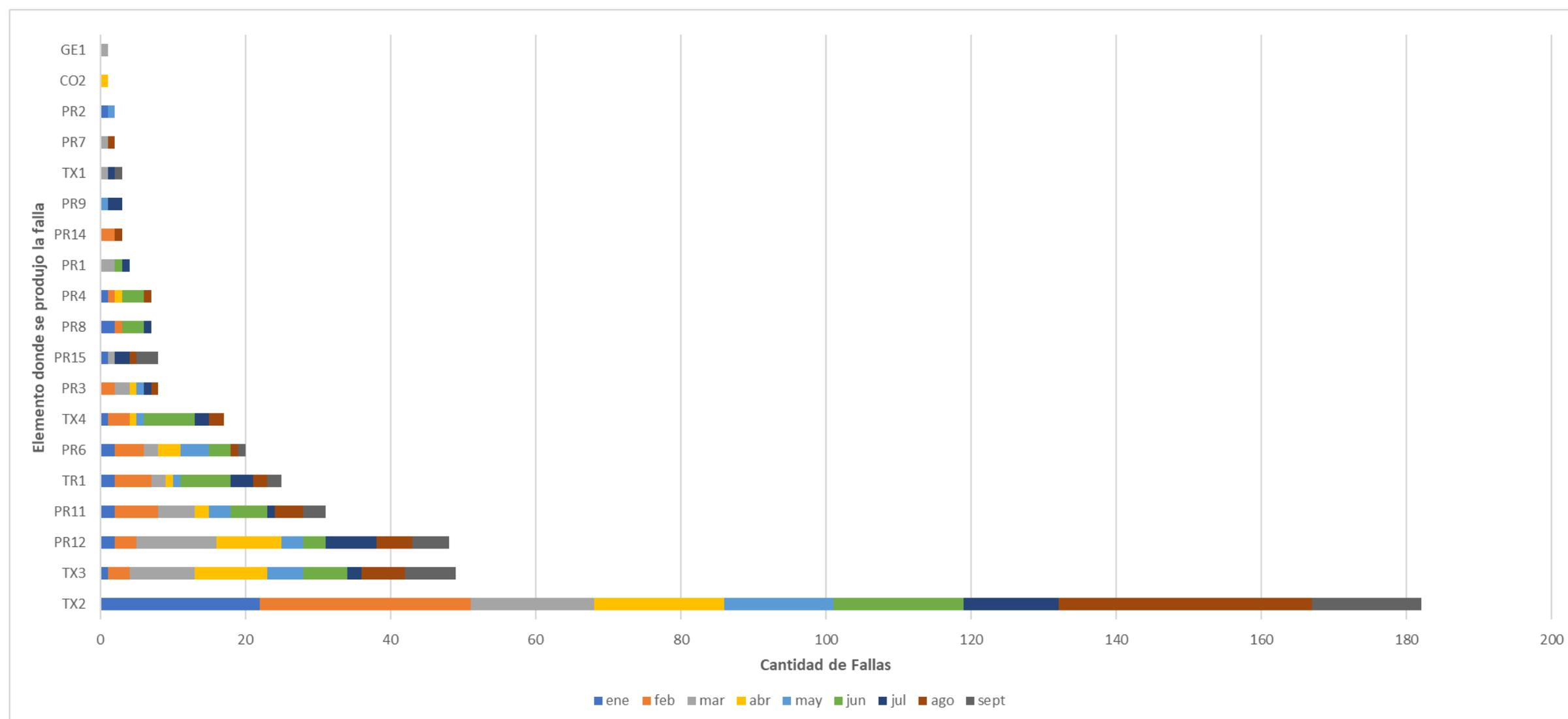
El gráfico de la figura anterior muestra la distribución de la cantidad de fallas en instalaciones del SEN según el “Elemento” del sistema de transmisión donde se originó la falla, hasta el mes de septiembre de 2023.
