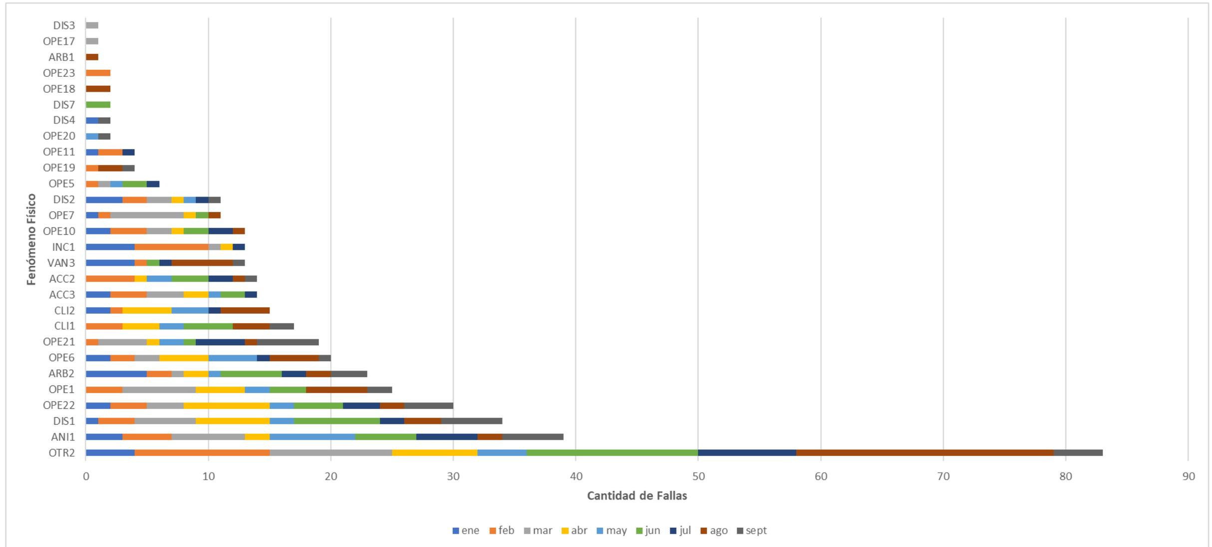
El gráfico de la figura anterior muestra la distribución de la cantidad de fallas en instalaciones del SEN según el “Fenómeno Físico” que originó la falla en el “Elemento” del sistema de transmisión, hasta el mes de septiembre de 2023.
