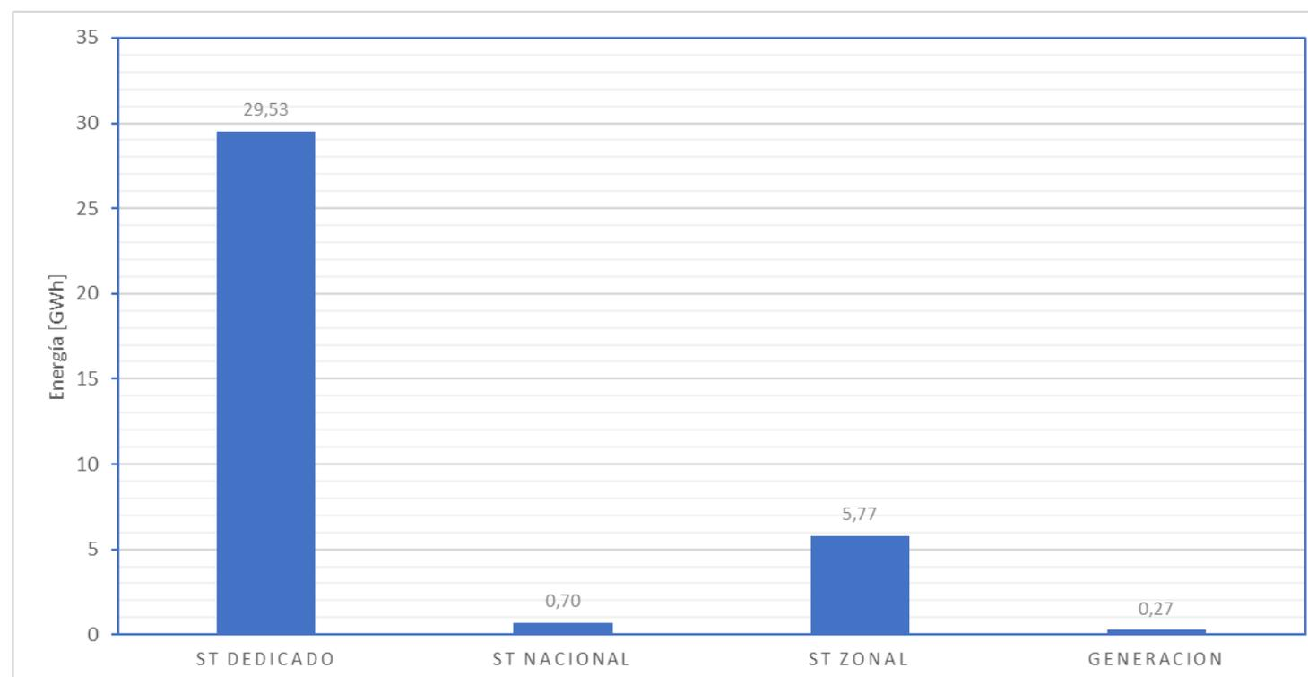
El gráfico de la figura anterior muestra la ENS acumulada hasta el mes de septiembre de 2023 producto de fallas en el SEN que afectaron de manera directa consumos de clientes, según el segmento de la instalación del sistema de transmisión donde se originó la falla.
