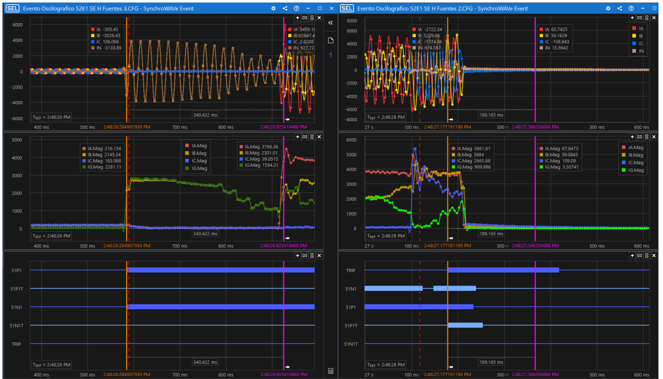
Registros N°1 (inicio de la falla) y N°2 (operación) del Relé SEL 351R E1 SE Hernán Fuentes.
