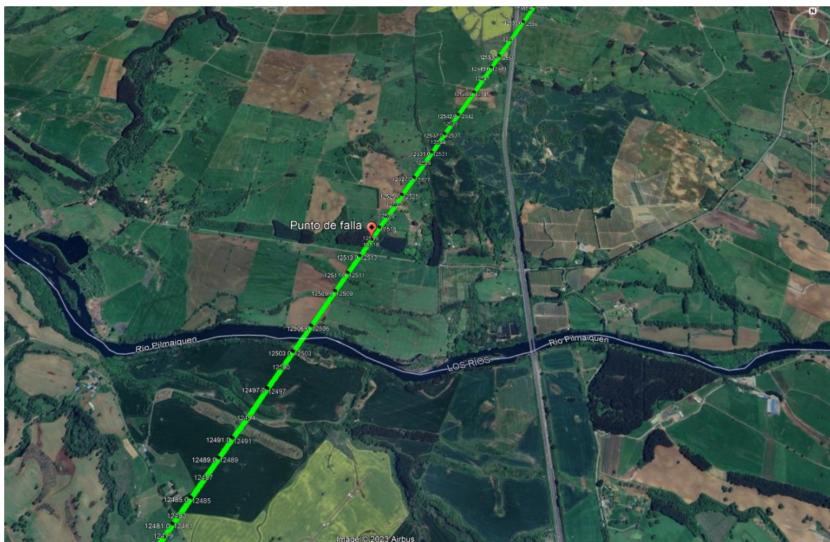
Fotografía Nro. 01: Punto de falla en estructura 192 (código AT 12514) línea 66 kV Remehue – Los Tambores. Punto geo referencia ( -40.377547, -73.012650).
