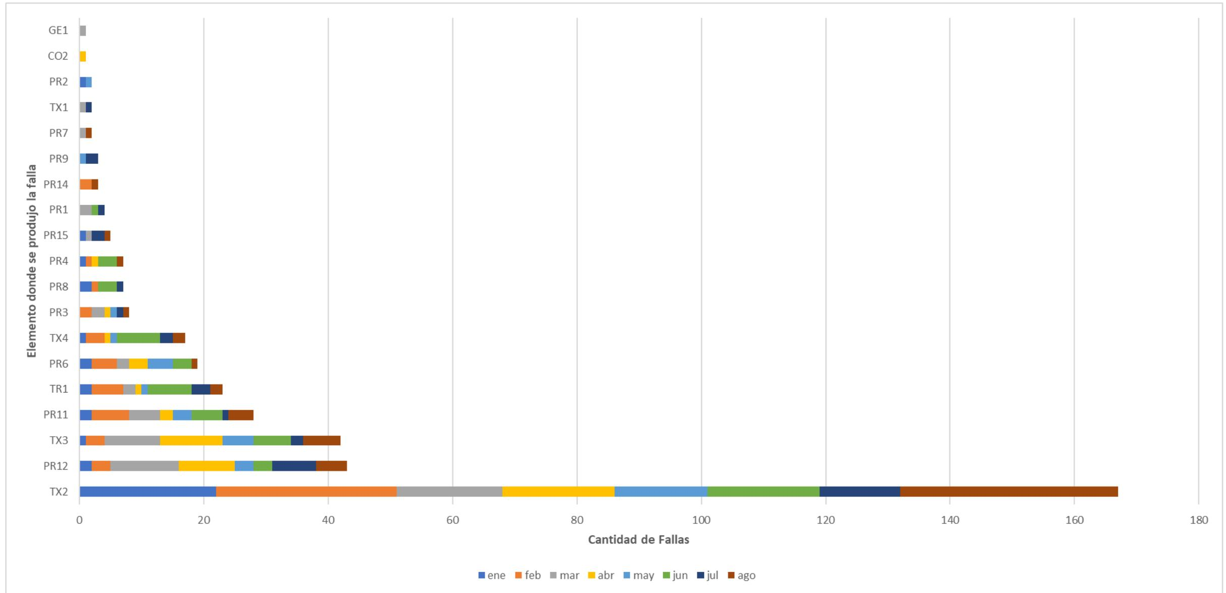
El gráfico de la figura anterior muestra la distribución de la cantidad de fallas en instalaciones del SEN según el “Elemento” del sistema de transmisión donde se originó la falla, hasta el mes de agosto de 2023.
