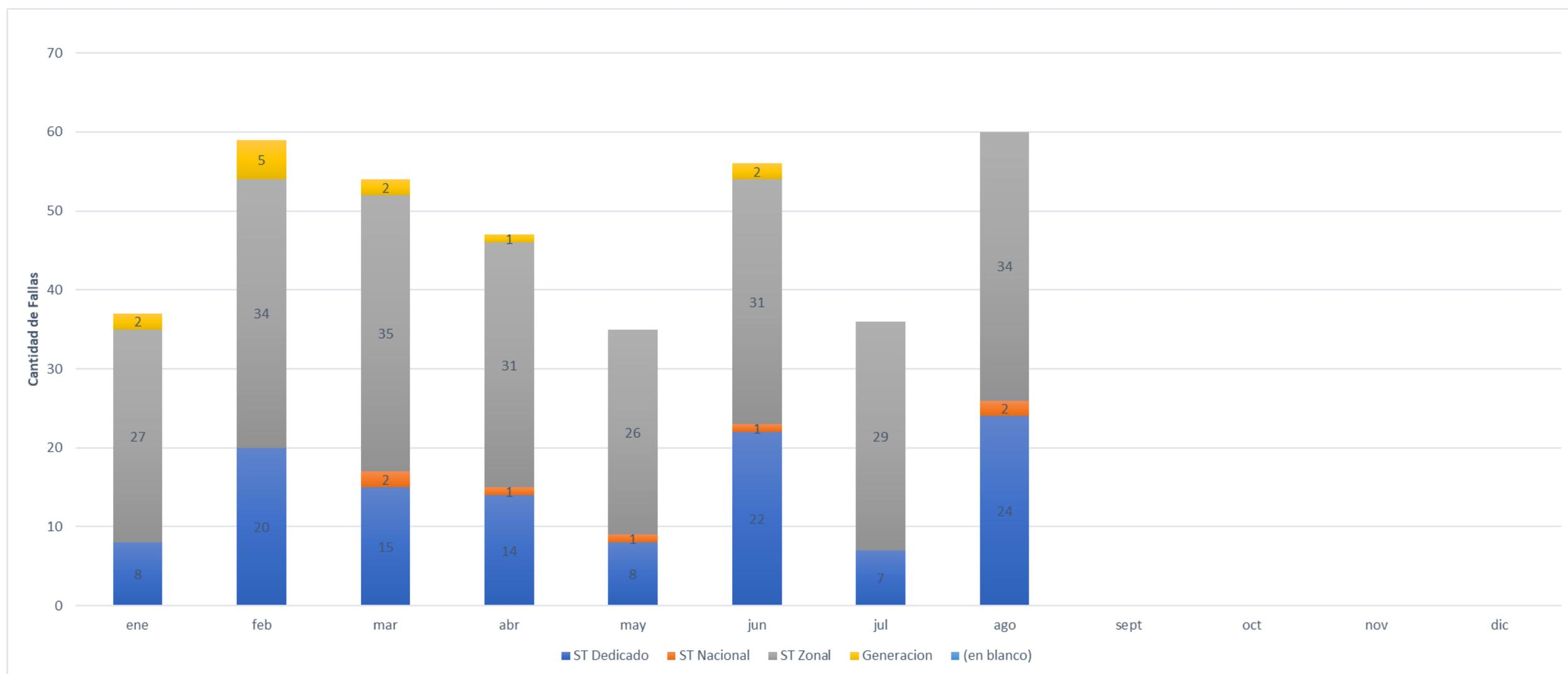
El gráfico de la figura anterior muestra la distribución mensual de la cantidad de fallas en instalaciones del SEN que afectaron de manera directa consumos de clientes, hasta el mes de agosto de 2023, según el segmento de la instalación del sistema de transmisión donde se originó la falla.
