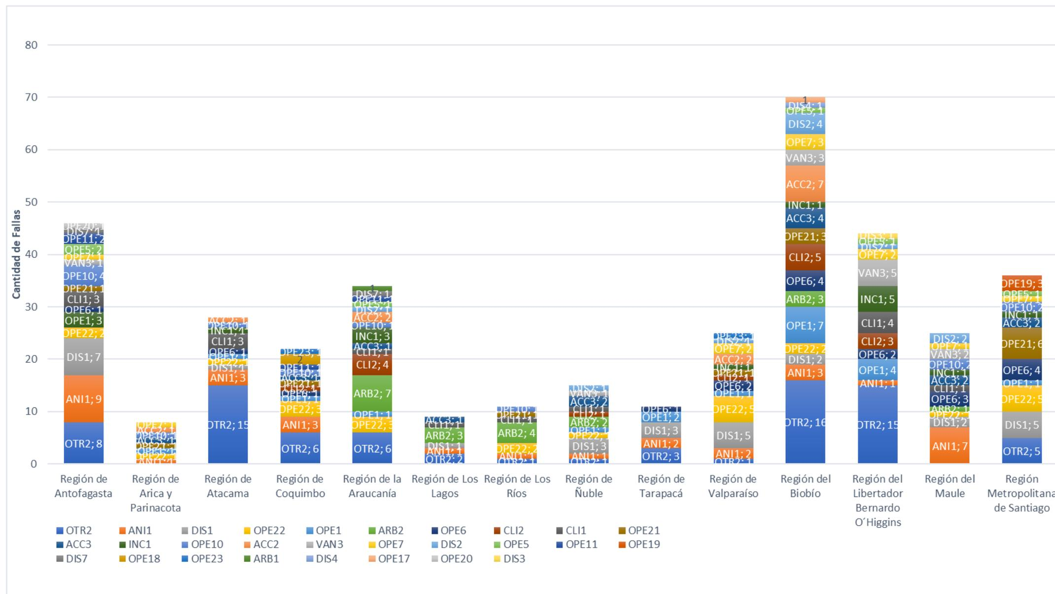
El gráfico de la figura anterior muestra la distribución por región de la cantidad de fallas en instalaciones del SEN que afectaron de manera directa consumos de clientes, hasta el mes de agosto de 2023, según el “Fenómeno Físico” que originó la falla en el “Elemento” del sistema de transmisión.
