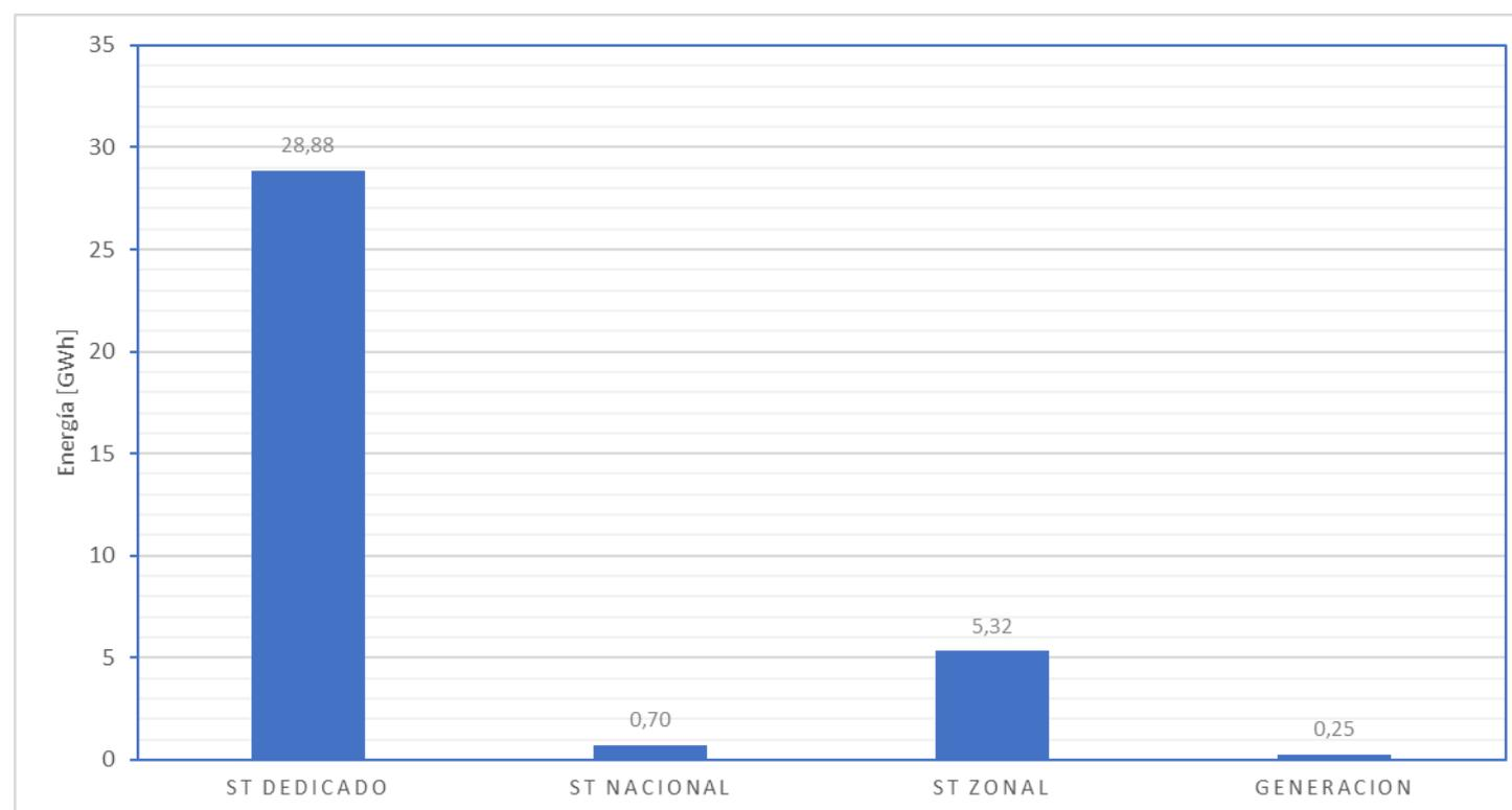
El gráfico de la figura anterior muestra la ENS acumulada hasta el mes de agosto de 2023 producto de fallas en el SEN que afectaron de manera directa consumos de clientes, según el segmento de la instalación del sistema de transmisión donde se originó la falla.
