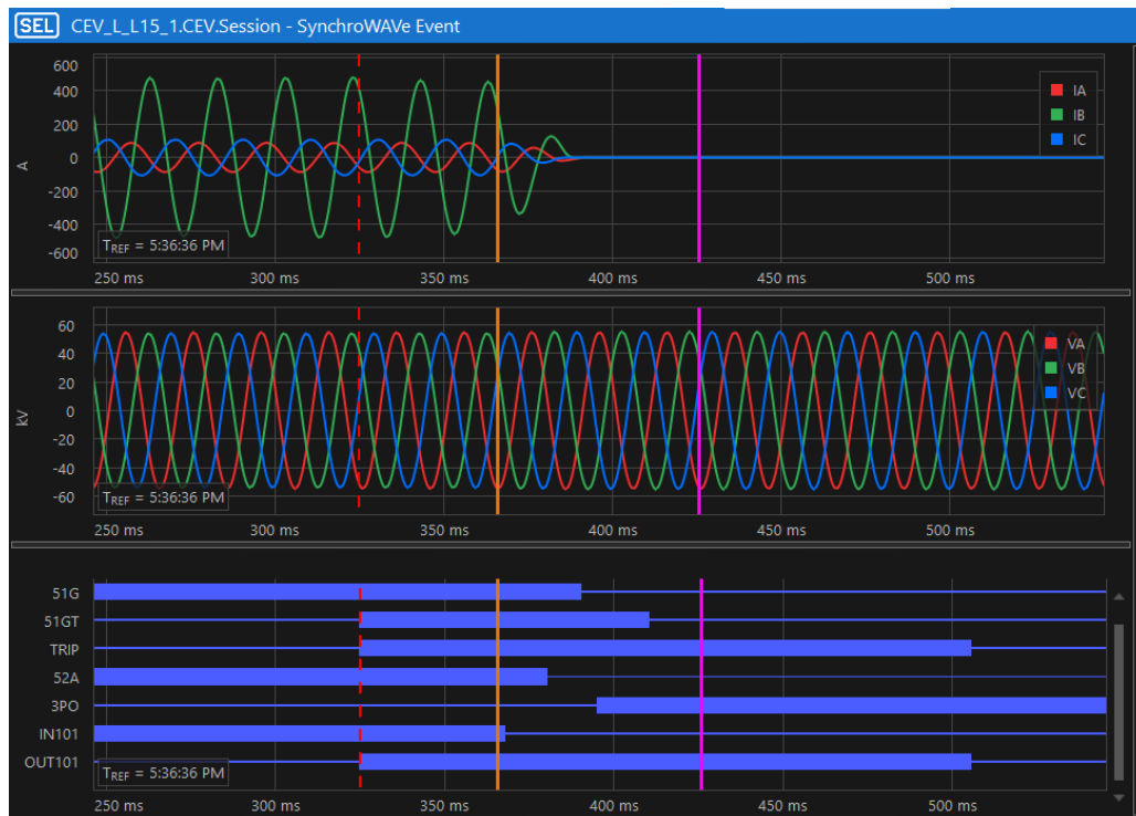
Evento N° 2.- Oscilografía variables analógicas y digitales, 52B1 S/E Los Peumos.
