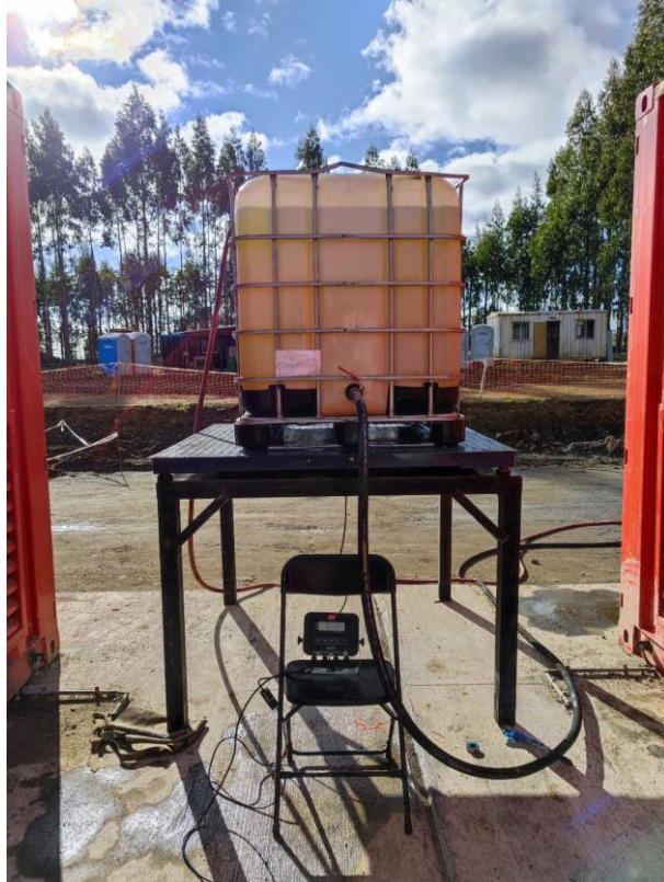
Figura 3: Instalación auxiliar para medición de consumo de combustible por masa
