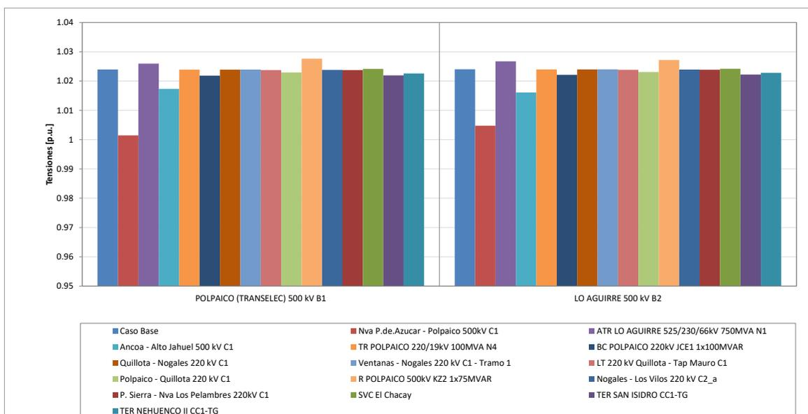
Figura 16 Tensiones en barras de 500 kV de la Zona Centro en E3.
