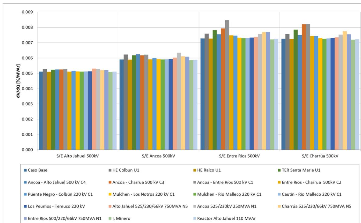
Figura 18 Sensibilidad de tensión ( $dV/dQ$ ) en barras de 500kV del Centro Sur en E5 Dmax.
