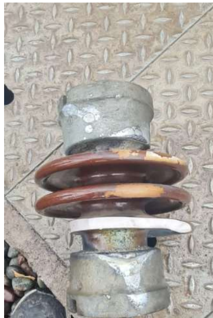
Aislador con descarga eléctrica
