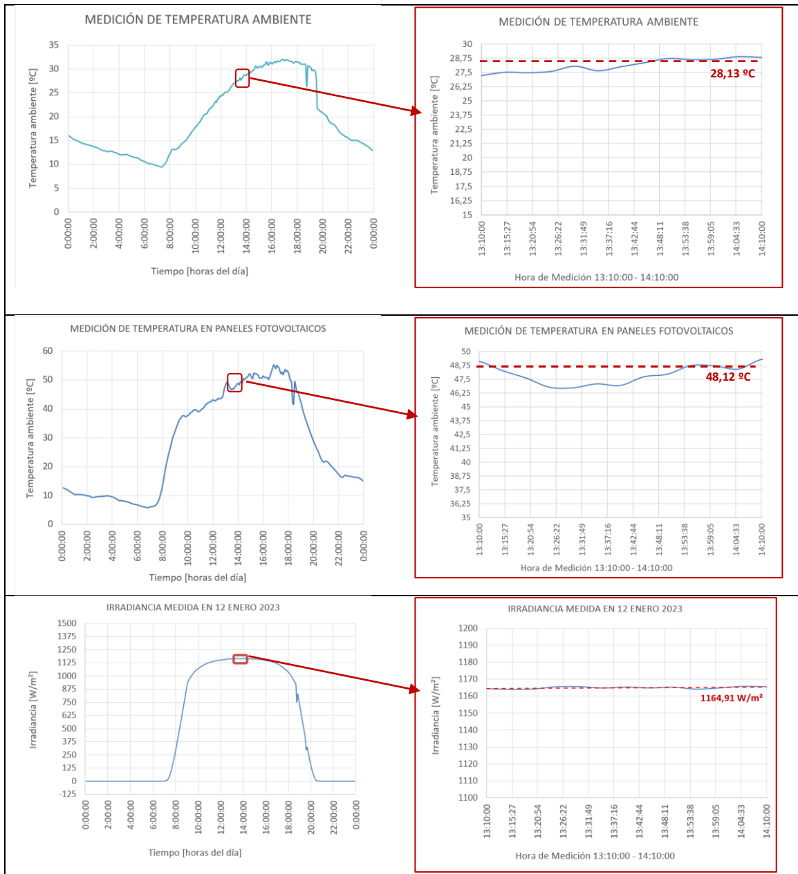
Figura 7-5 Mediciones de temperatura ambiente y en paneles fotovoltaicos e irradiancia en PV Coya
