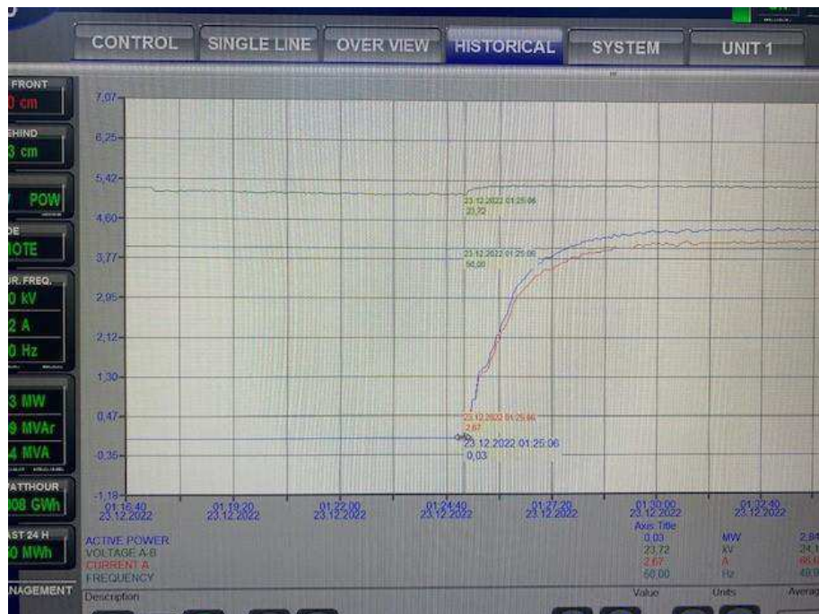
Figura 3: Registro conexión en SCADA Central Hidroeléctrica Renaico.
