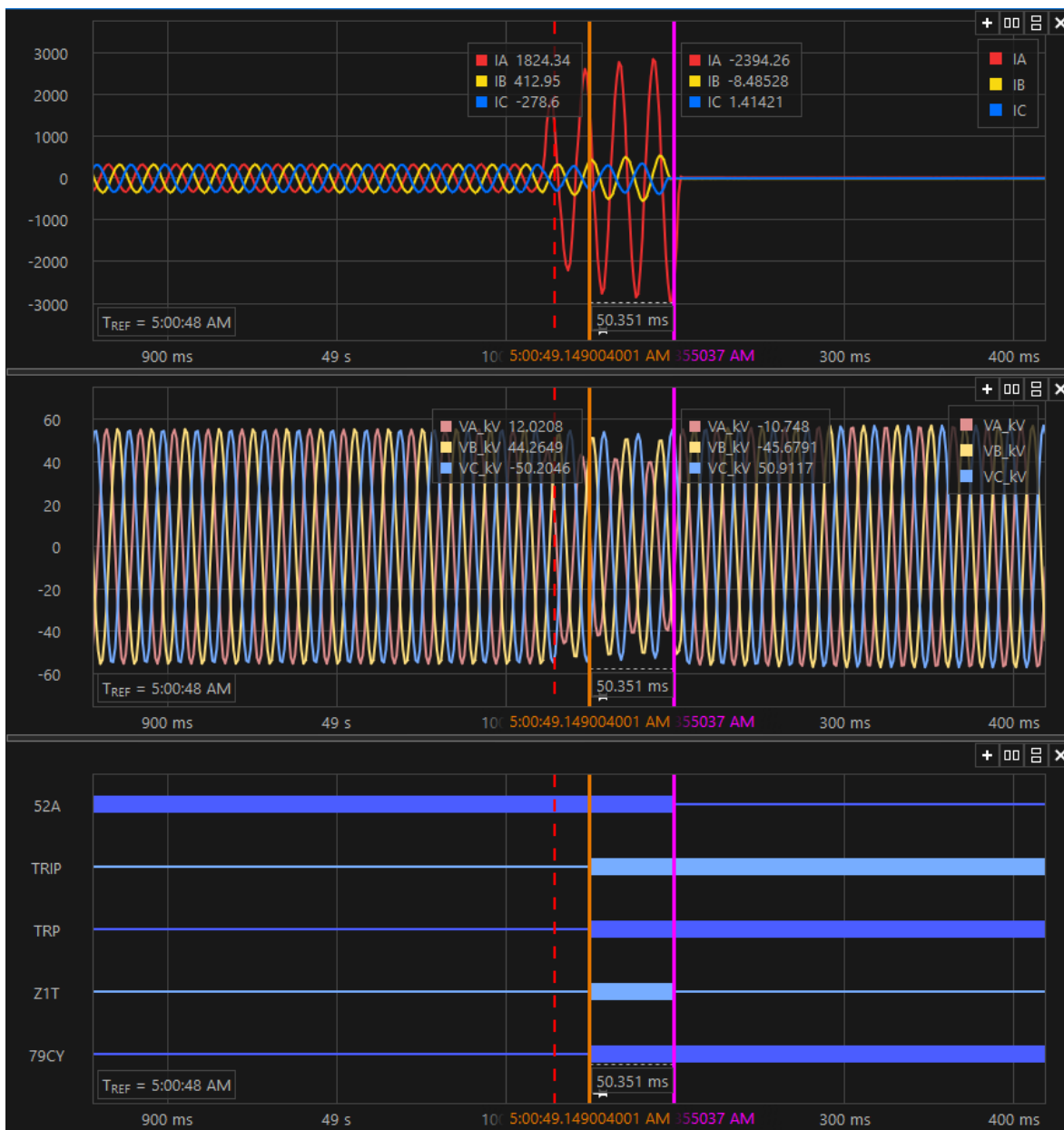
Registro oscilografico Relé Schweitzer SEL 311C Paño 52B3 Rancagua.
