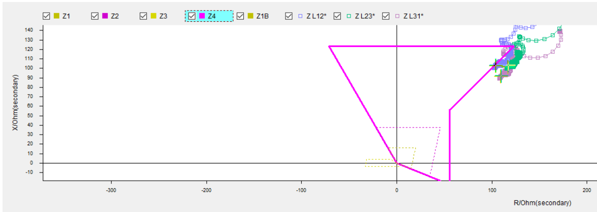
Figura 4.2: Mordisco de carga para desconexión de las 09:55 horas del 16-12-2022.
