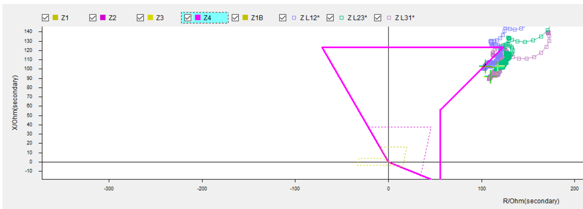
Figura 4.2: Mordisco de carga para desconexión de las 09:55 horas del 16-12-2022.
