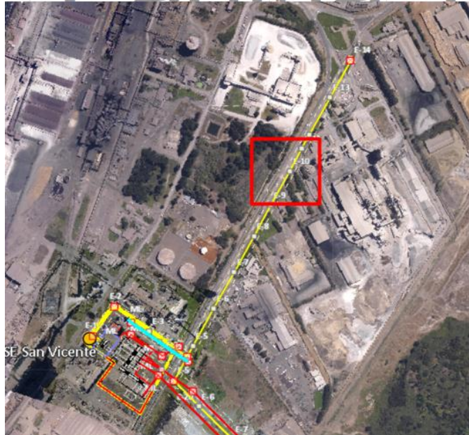
Figura 3: Ubicación de las estructuras N°9 y 10 que sufrieron robo de conductor.
