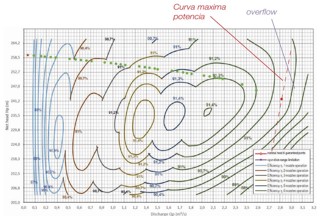
**OVERFLOW** La turbina por su constitución, puede operar en una condición denominada “overflow”. Esta debe ser considerada como una condición excepcional, que no hace parte de la normal operación de la turbina misma.
