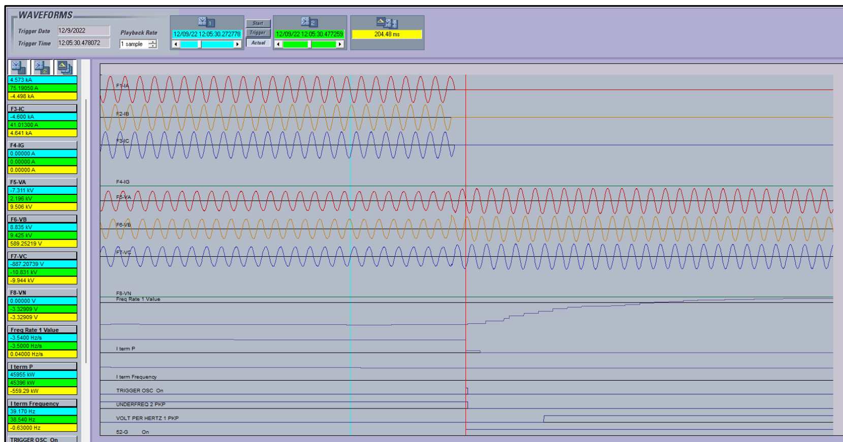
Figura 8.4: Oscilografía de protección G60, turbogenerador TG3 central autoprodutora Nueva Aldea. 5
