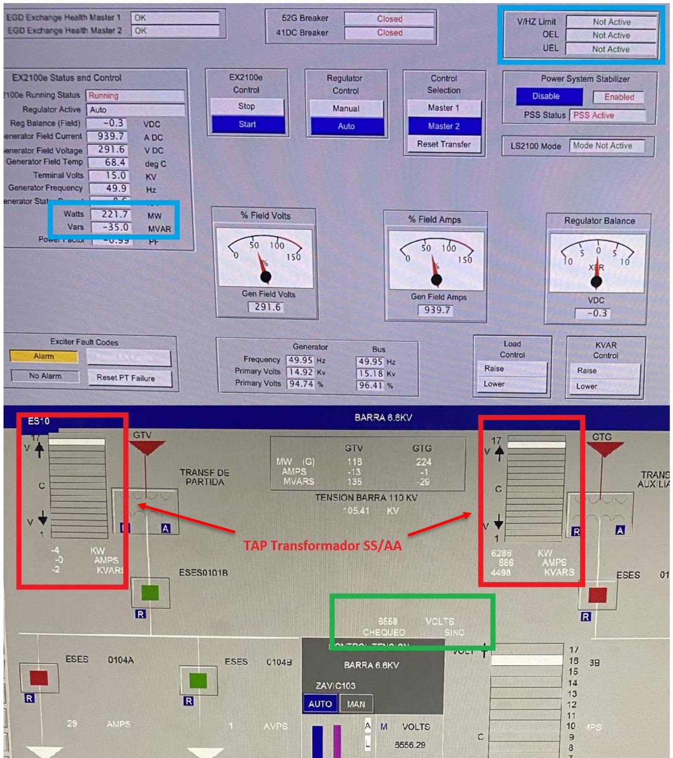
Figura 9.36: Posición de tap utilizado durante pruebas subexcitadas de curva PQ – Estado de carga P5
