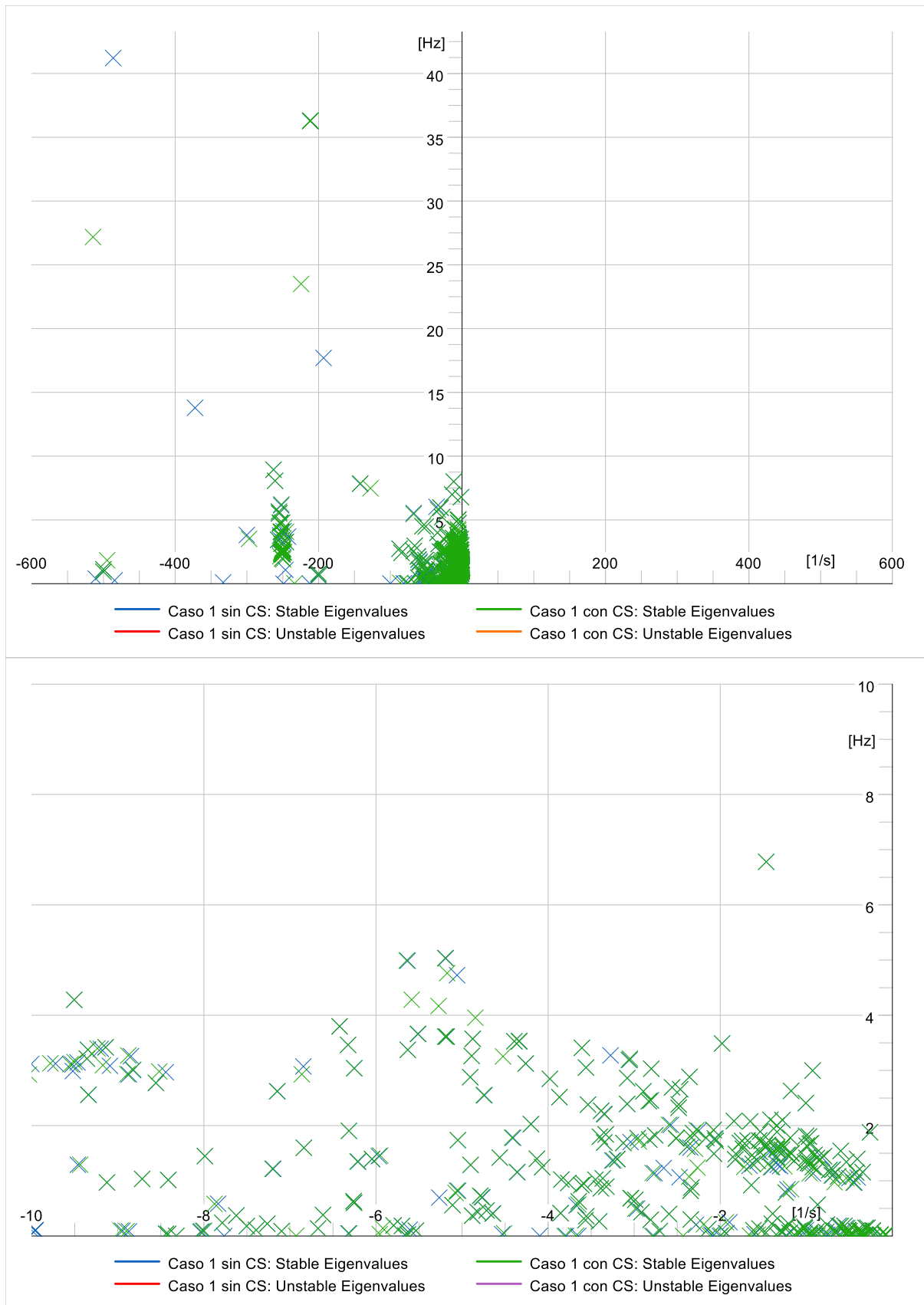
Figura 6. Autovalores en el Caso 1 ( ESCR \geq 1,3 ) con y sin los condensadores sincrónicos de la solución
