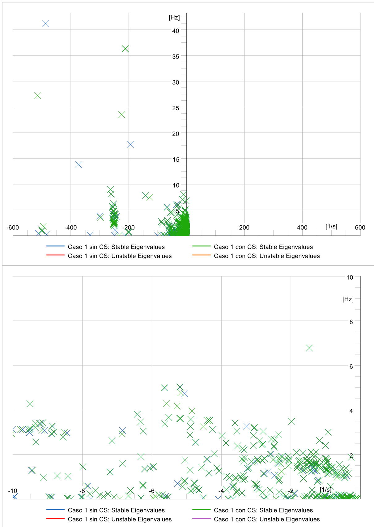
Figura 20. Autovalores en el Caso 1 ( ESCR \geq 1,3 ) con y sin los condensadores sincrónicos de la solución
