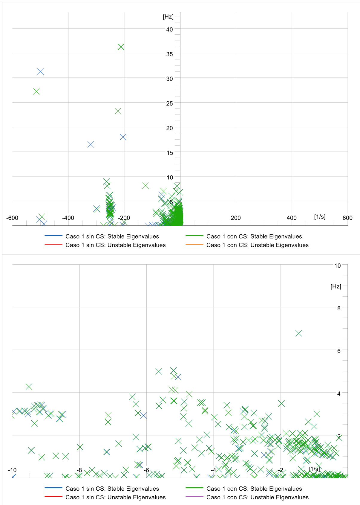
Figura 18. Autovalores en el Caso 0.B ( ESCR \geq 1,3 ) con y sin los condensadores sincrónicos de la solución
