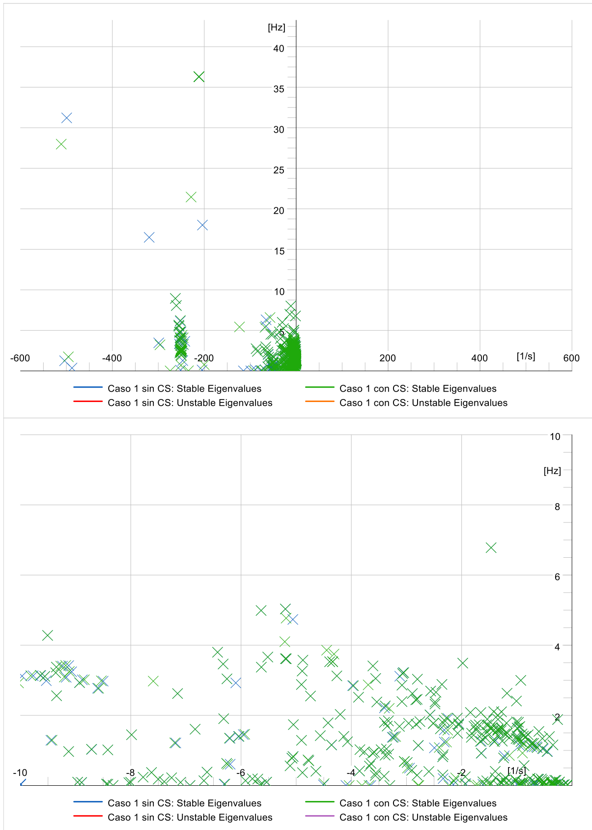
Figura 17. Autovalores en el Caso 0.B ( ESCR \geq 1,5 ) con y sin los condensadores sincrónicos de la solución
