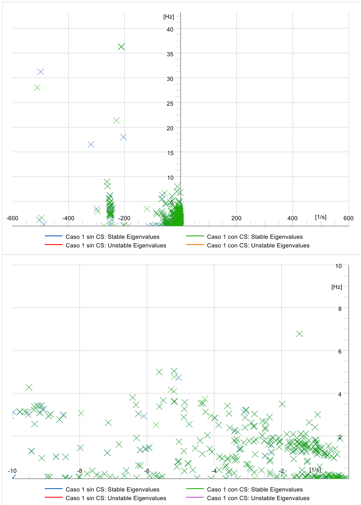
Figura 15. Autovalores en el Caso 0.A ( ESCR \geq 1,5 ) con y sin los condensadores sincrónicos de la solución
