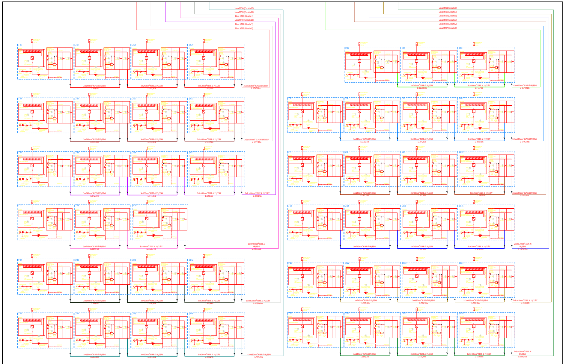
Figura 3.12: Diagrama unilíneal de alimentadores y centros de transformación PFV Diego de Almagro Sur.
